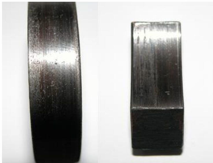
Рисунок 4.4 – Поверхні тертя вихідних зразків
