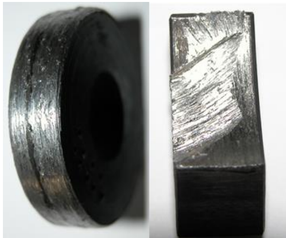
Рисунок 4.26 – Поверхня тертя диск-сталь та колодка-сталь без покриття
