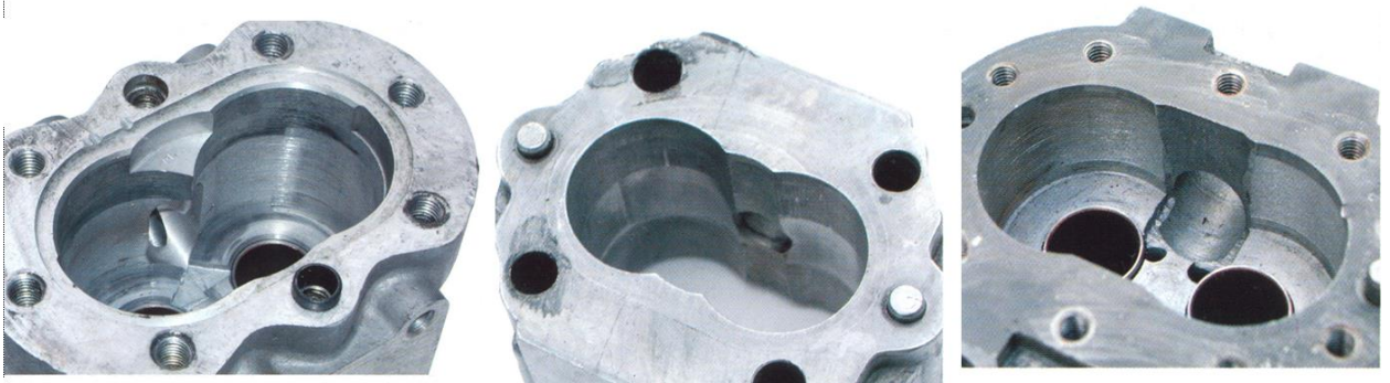
Рисунок 1.6 – Корпус насоса зі слідами абразивного зносу[14]
