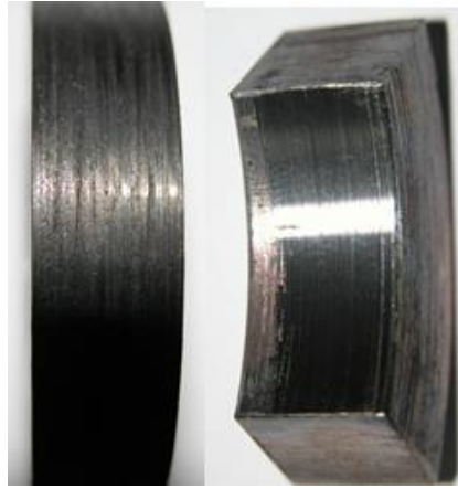
Рисунок 4.30 – Поверхня тертя зразків диск-сталь та колодка-сталь з покриттям
