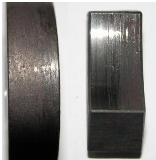
Рисунок 4.16 – Поверхня тертя зразків колодки-сталь без покриття, диск-чавун з покриттям
