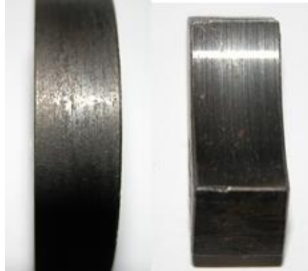
Рисунок 4.12 – Поверхня тертя зразків колодка-сталь з покриттям, диск-чавун без покриття
