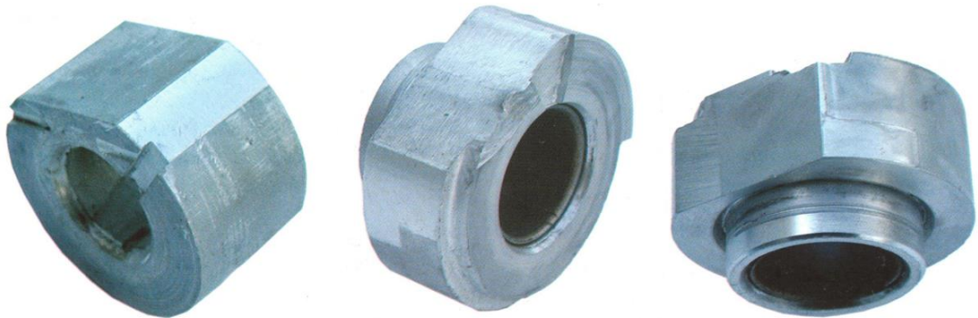
Рисунок 1.5 – Торцеві поверхні втулок зі слідами абразивного зносу[14]
