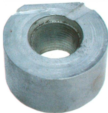
Рисунок 1.9 – Сліди ерозії на торці втулки [14]
