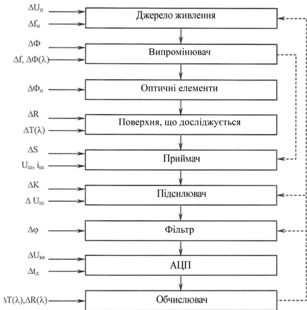
Рисунок 2.10 – Структурна схема перетворення сигналів та джерела похибок приладу вимірювання кольору
