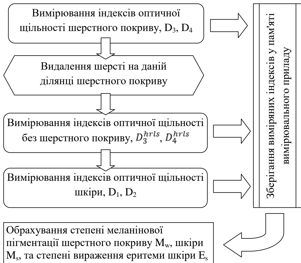
Рисунок 3.1 – Спосіб визначення фізико-біологічних характеристик шерстного покриву та шкіри тварин
