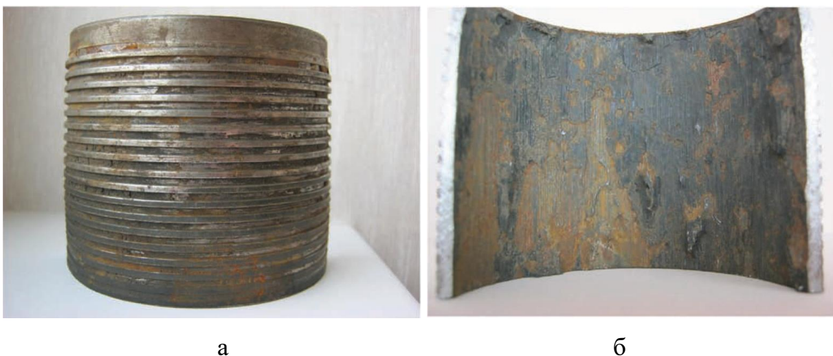
Рисунок 3.10 – Вид поверхні різьбового з'єднання (а) і внутрішня його поверхня (б) (суцільна виразкова корозія)
