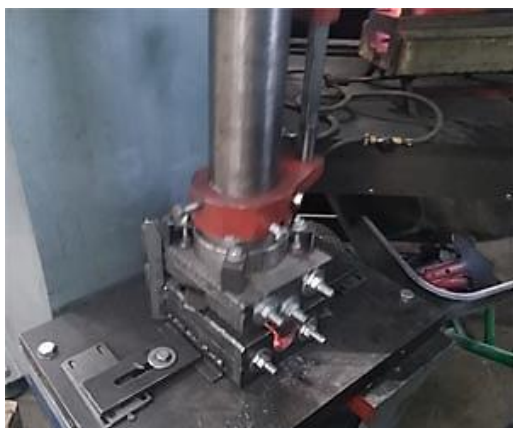
Рисунок 1.4 – Гаряче штампування на пресі
