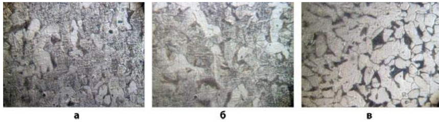
Рисунок 5.12 – Неоднорідна структура вихідного металу Сталі 20пс в повздовжньому напрямку після деформації, що містить 5-8% (а), 8-10% (б) і 10-12% (в) перліту відповідно. Травлення 4%-вим розчином \text{HNO}_3 , \times 1000 [79, 242]
