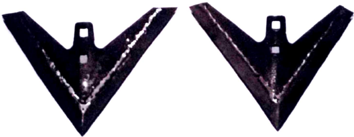
Рисунок 6.6 – Відновлена культиваторна лапа за запропонованою технологією
