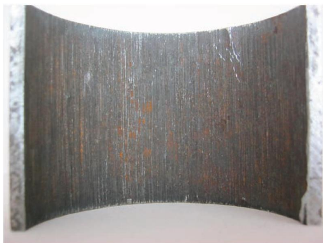
Рисунок 3.11 – Вид поверхні тіла НКТ (а) і внутрішньої поверхні НКТ (б) (суцільна корозія без наскрізних отворів із хвилеподібним профілем)
