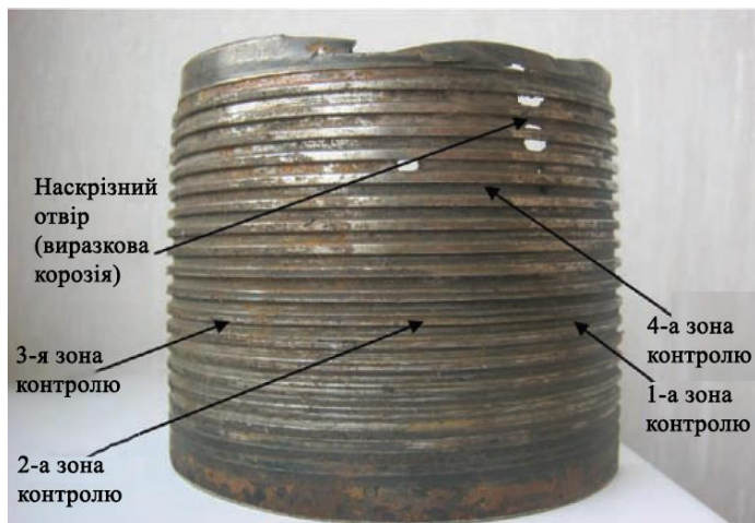
Рисунок 3.8 – Різьбове з'єднання зовнішньої поверхні (фрагмент НКТ), зруйноване виразковою корозією
