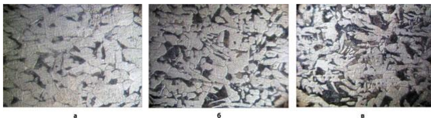
Рисунок 5.11 – Неоднорідна структура вихідного металу Сталі 20пс в стані поставки (зона захвату), що містить 8-10% (а), 18-20% (б) і 20-25% (в) перліту відповідно.
