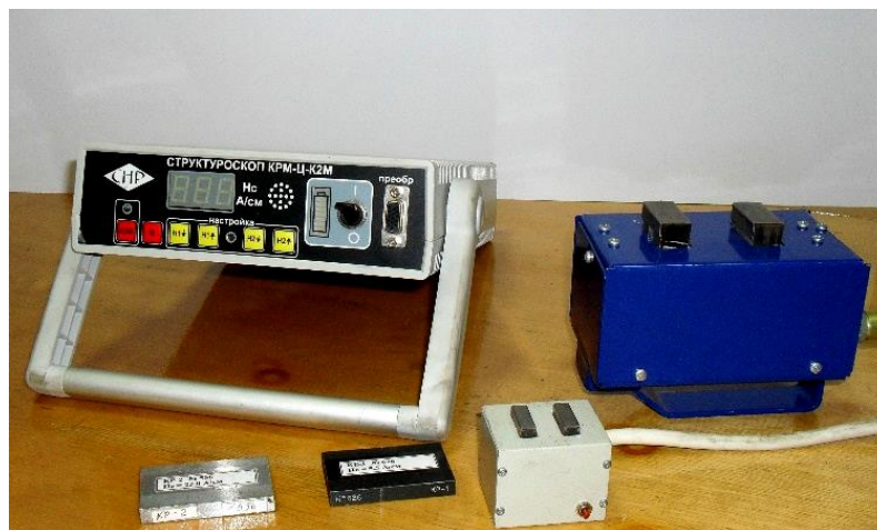
Рисунок 2.8 – Загальний вид коерцитиметра КРМ-Ц-К2М з різними накладними перетворювачами
