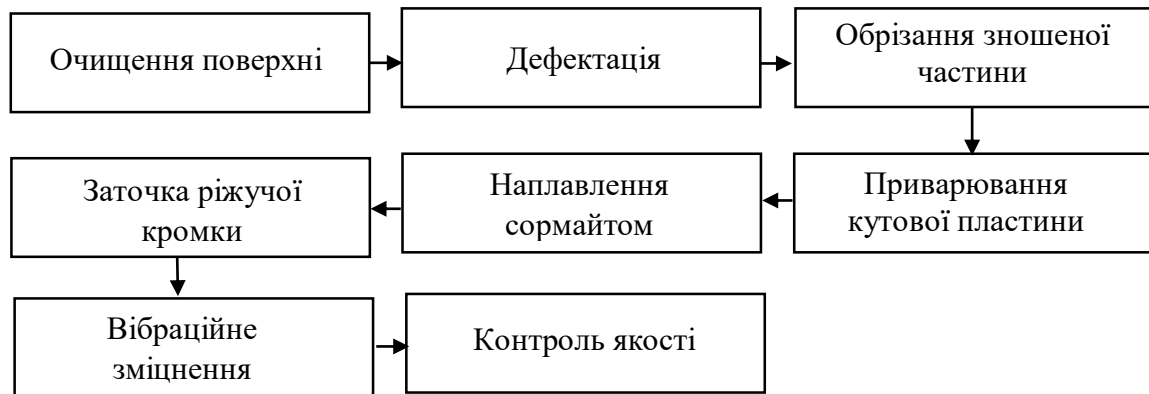
Рисунок 6.3 – Схема технологічного процесу відновлення і зміцнення стрілчастих лап культиватора
