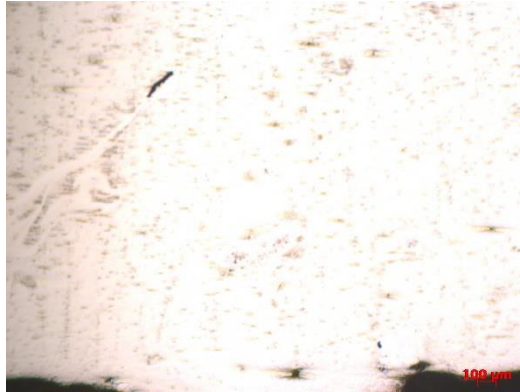
Рисунок 4.12- Неметалеві включення в покритті відновленого шару електродом Т-620 з модифікуванням глиною, \times 200
