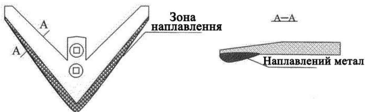
Рисунок 1.9 – Лапа з навареним запасом металу з тильної сторони
