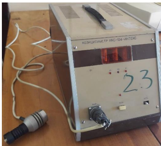
Рисунок 2.9 – Загальний вигляд коерцитиметра ІКС-104-ІНТЕКС з перетворювачем
