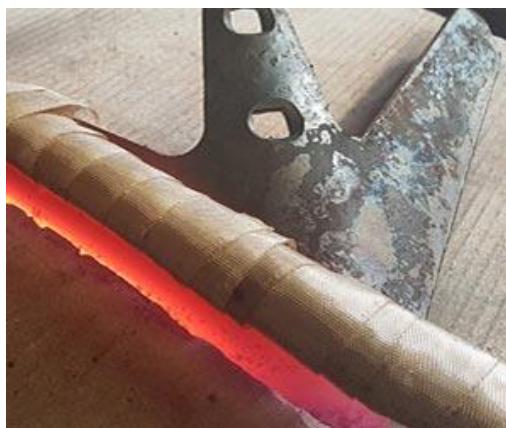
Рисунок 1.5 – Загартування ТВЧ з електронним керуванням
