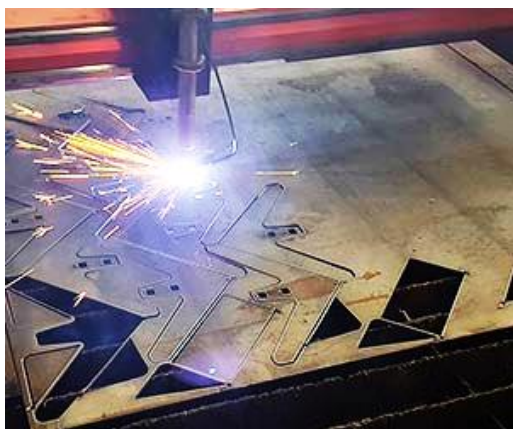
Рисунок 1.2 – ЧПУ плазмове різання
