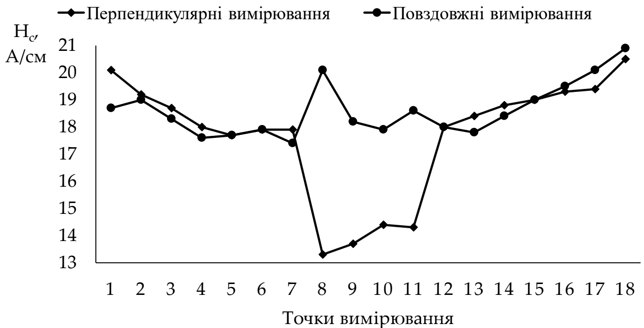
Рисунок 3.26 – Показання коерцитивної сили в новій культиваторній лапі
