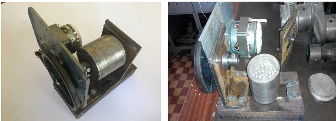
Рисунок 2.2 – Зовнішній вигляд кульового млина
