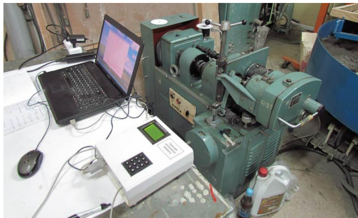
Рис. 3.13. Машина тертя СМЦ-2, модернізована електронним блоком для визначення моменту тертя
