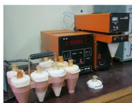
Рис. 3.6. Загальний вид аналізатора механічних домішок фотометричного рахункового типу ФС - 151
