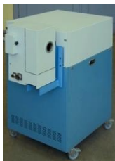
Рис. 3.7. Загальний вид оптично-емісійного спектрометру для діагностики моторних та трансмісійних олів МФС-11
