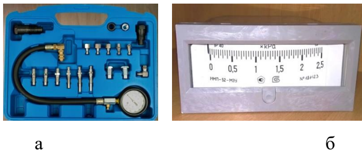
Рис. 3.9. Обладнання для визначення параметрів циліндро-поршневої групи двигуна втнутрішнього згорання: а - HS-A1019; б - НМП-52.
