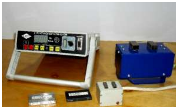
Рис. 2.6 Коерцитиметр моделі КРМ-Ц-2М
