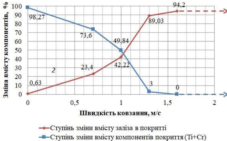
Рис. 4.7 – Залежність зміни концентрації компонентів покриття і основи при різних швидкостях ковзання
