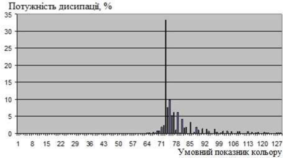
Рис. 11 – Розподіл потужностей дисипації на вихідній поверхні серійних кілець, які в подальшому випробовувалися при швидкості ковзання 1 м/с
