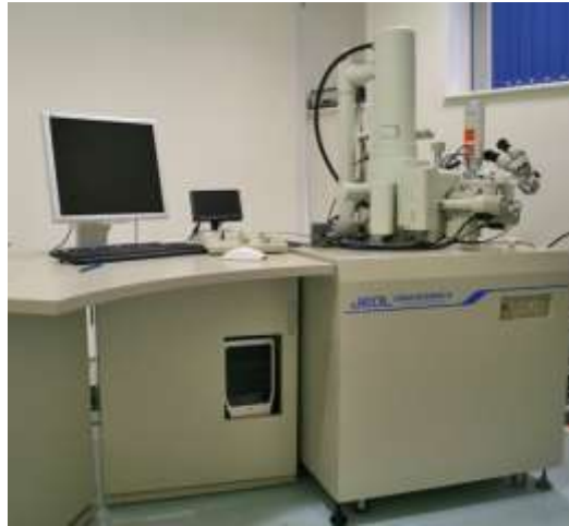
Рис. 2.13 Скануючий електронний мікроскоп JSM-6390LV
