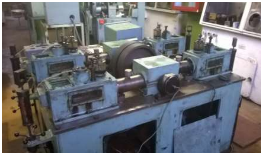
Рис. 2.7 Машина тертя зі зворотно-поступальним рухом
