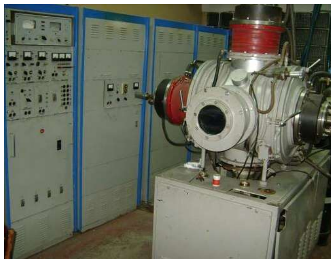
Рис. 2.4 Загальний вигляд устаткування «Булат-6»
