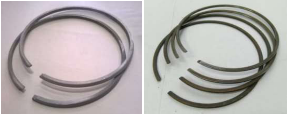
Рис. 2. Загальний вигляд маслоз'ємних поршневих кілець двигунів спеціальної техніки
