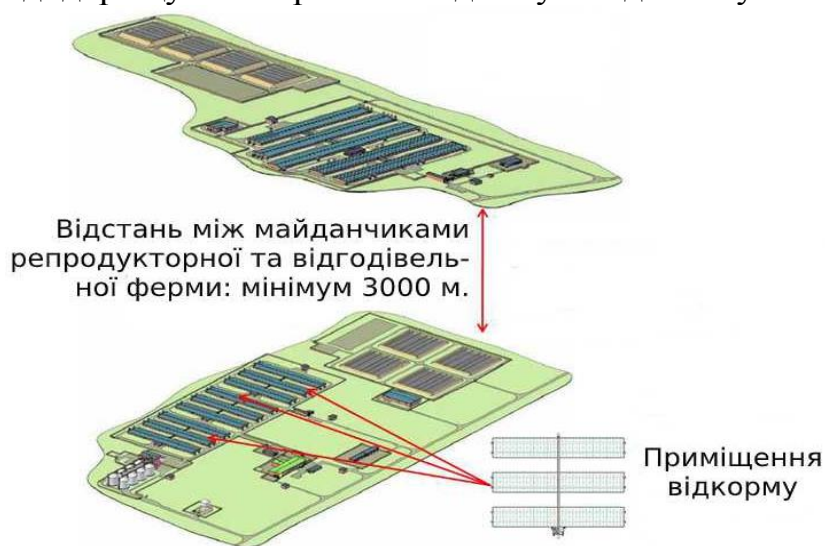
Рисунок 2 – Приклад дво-майданчикової системи утримання свиней
