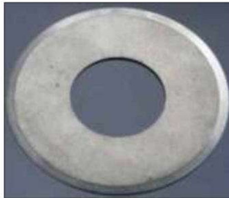
Рисунок 2.3 – Зовнішній вигляд різального інструмента для подрібнення горіхів
