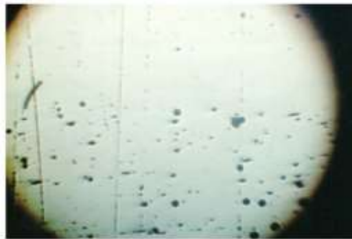
Рис4.1 – Гальмування включень у основному металі при нанесенні покриття ×100
