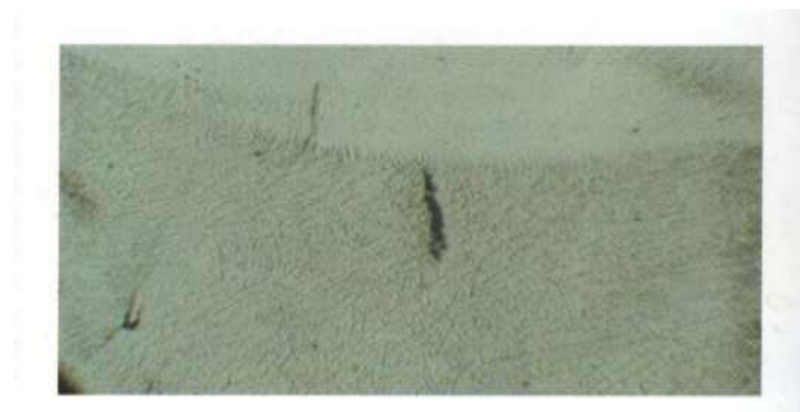
Рис.3.9 – Формування тонкої дендритної структури в наплавленому шарі без модифікуючої домішки x100
