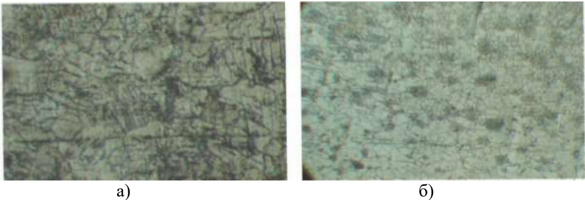
а) – при наплавленні без домішок; б) – з введенням модифікатора Рис.3.6 – Подрібнення зерен при введенні модифікуючої домішки \times 100
