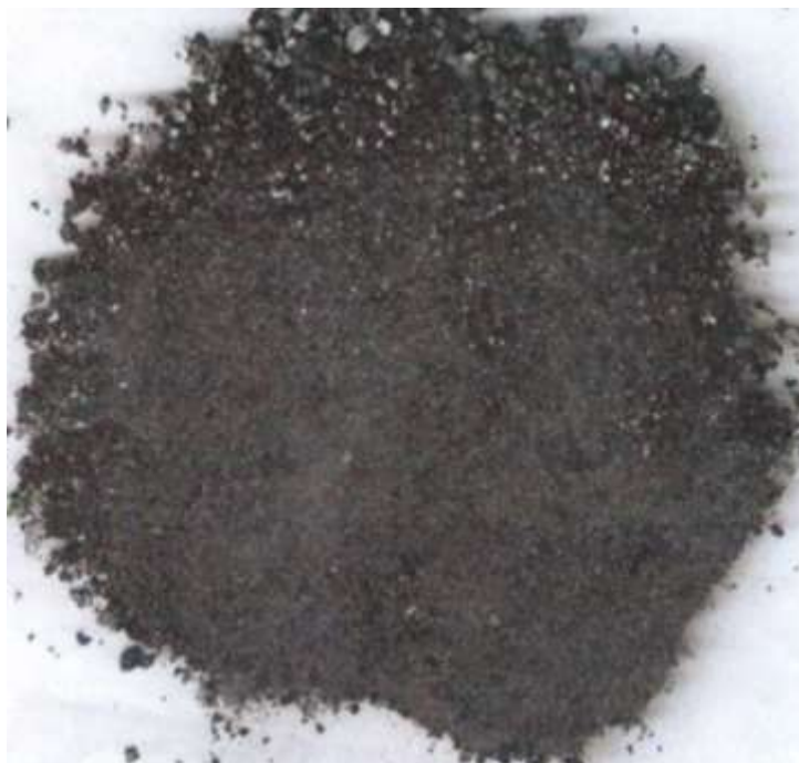
Рис.3.3 – Змішана дрібна фракція магнітної і немагнітної шихти від утилізації боєприпасів
