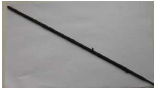
Рис.4.8 – Електрод з нанесеною на його поверхню обмазкою
