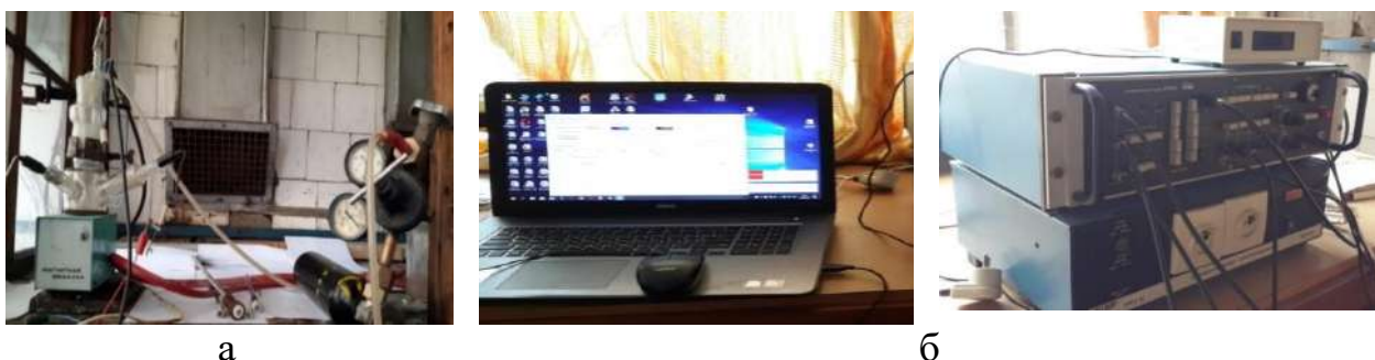
Рисунок 2.5 – Установа для моделювання технологічних умов протікання корозійних процесів (а) і комплекс вимірювальних приладів для реєстрації циклічних вольтамперних кривих(б) [225]
