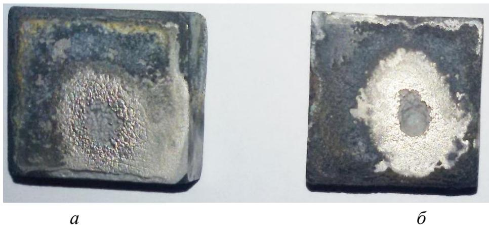
Рисунок 4.44 – Поверхня борованого зразка отриманого на сталі 15X11MФ при швидкісному нагріві СВЧ після випробувань на зношування (а), поверхня сталі 15X11MФ після покращення і дії абразивних часток (б)
