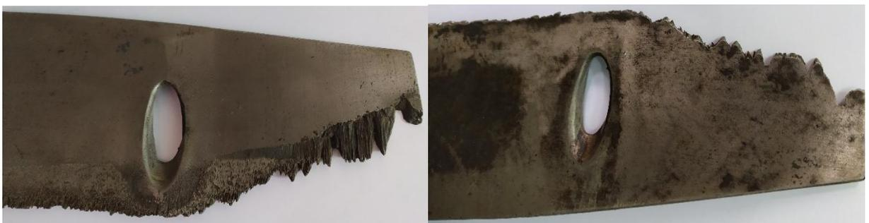
Рисунок 5.1 – Ерозійне зношування входної кромки лопатки парової турбіни після 100 тис. годин напрацювання
