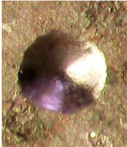
Рисунок 4.42 – Відсутність сколів на поверхні борованого шару отриманого з нагріванням СВЧ ( x 30 )
