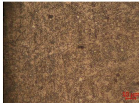
Рисунок 3.17 – Матрична структура сталі після повільного охолодження (x1000)
