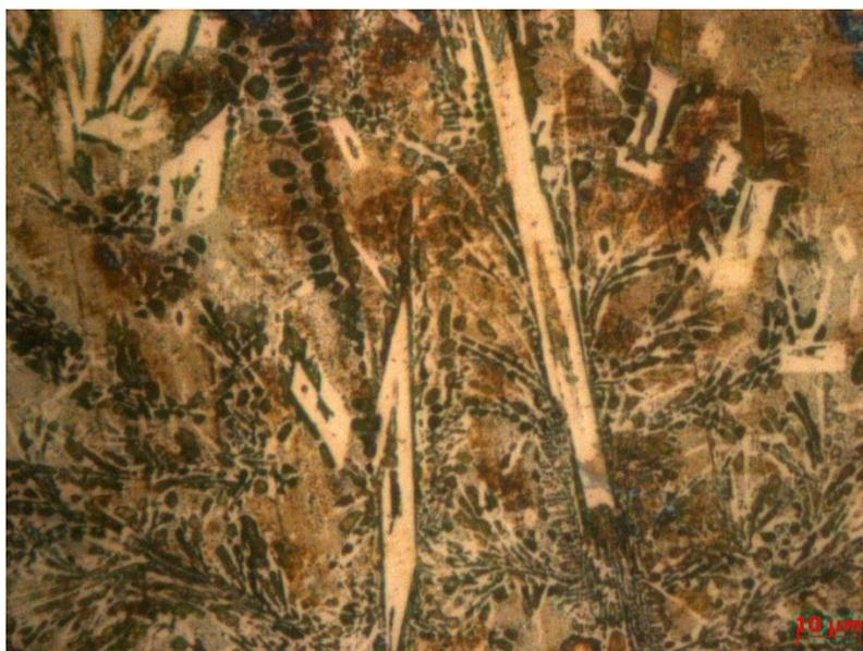
Рисунок 4.8 – Збільшення та утворення ланцюгів карбоборидної фази в умовах термоциклювання на сталі 15X11МФ
