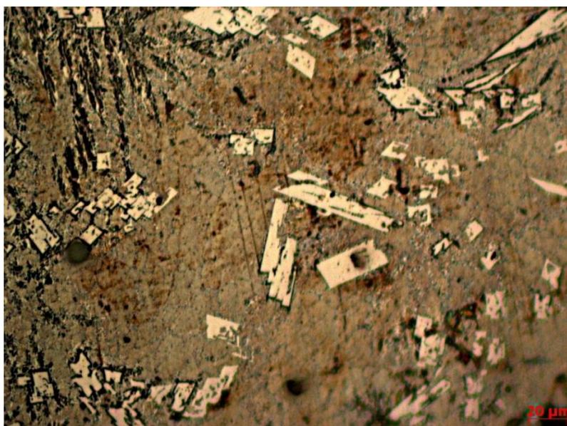
Рисунок 4.6 – Мікроструктура бориду, карбоборидів та твердого розчину в сталі 15X11МФ при зменшенні концентрації бору (  $\times 500$  )
