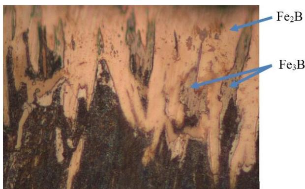
Рисунок 3.25 – Мікроструктура борованого шару на сталі 40X (x1000)
