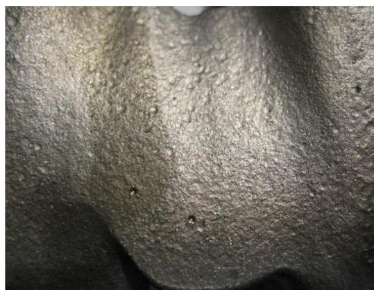
Рисунок 5.9 – Стан поверхні дробеметної зношеної лопатка після загартування і відпуску
