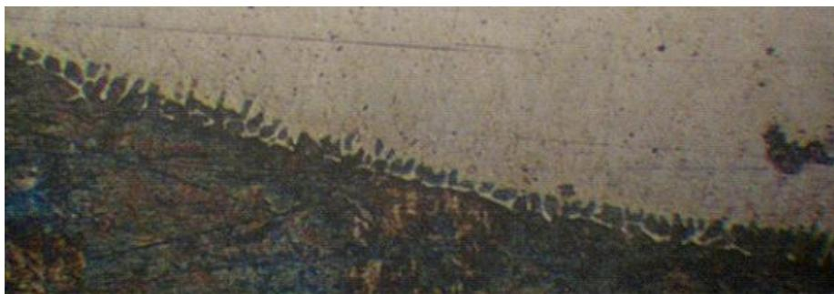
Рисунок 4.3 – Мікроструктура границі переходу від дифузійного до гартованого шару (x 500)
