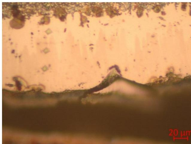
Рисунок 4.40 – Сколювання бориду  $Fe_2B$  на високолегованій сталі мартенситного класу при мікроіндентуванні ( x 500 )
