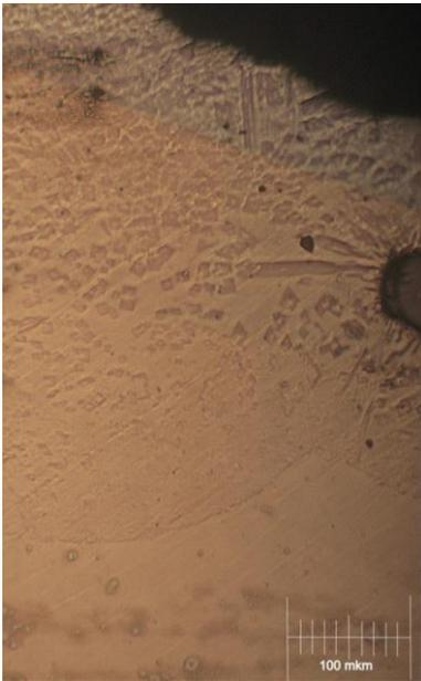
Рисунок 4.38 – Мікроструктура борованого шару, отриманого в умовах швидкісного нагрівання СВЧ у зразку з максимальною ударною в'язкістю (x200)
