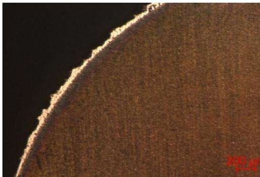
Рисунок 3.16 – Результати борування з більш повільним охолодженням (x50)
