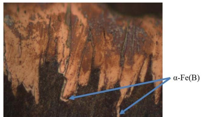
Рисунок 3.26 – Оболонкова структура твердого розчину бору навколо боридних голок (x1000)
