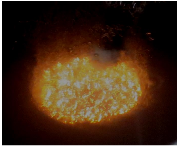
Рисунок 3.1 – Вид поверхневих мікророзрядів при окисдуванні алюмінію в мікродуговому режимі
