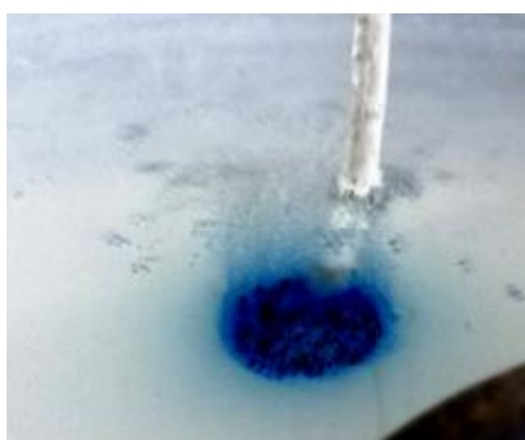
Рисунок 6.5 – Процес анодно-катодного оксидування в режимі мікродугових розрядів
