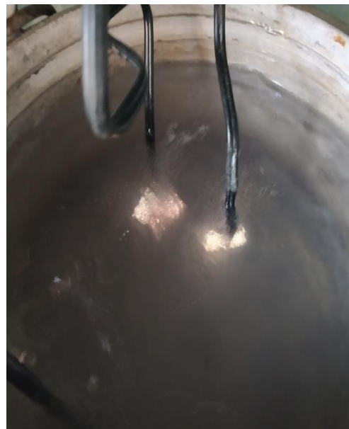
Рисунок 2.3 – Процес мікродугового оксидування
