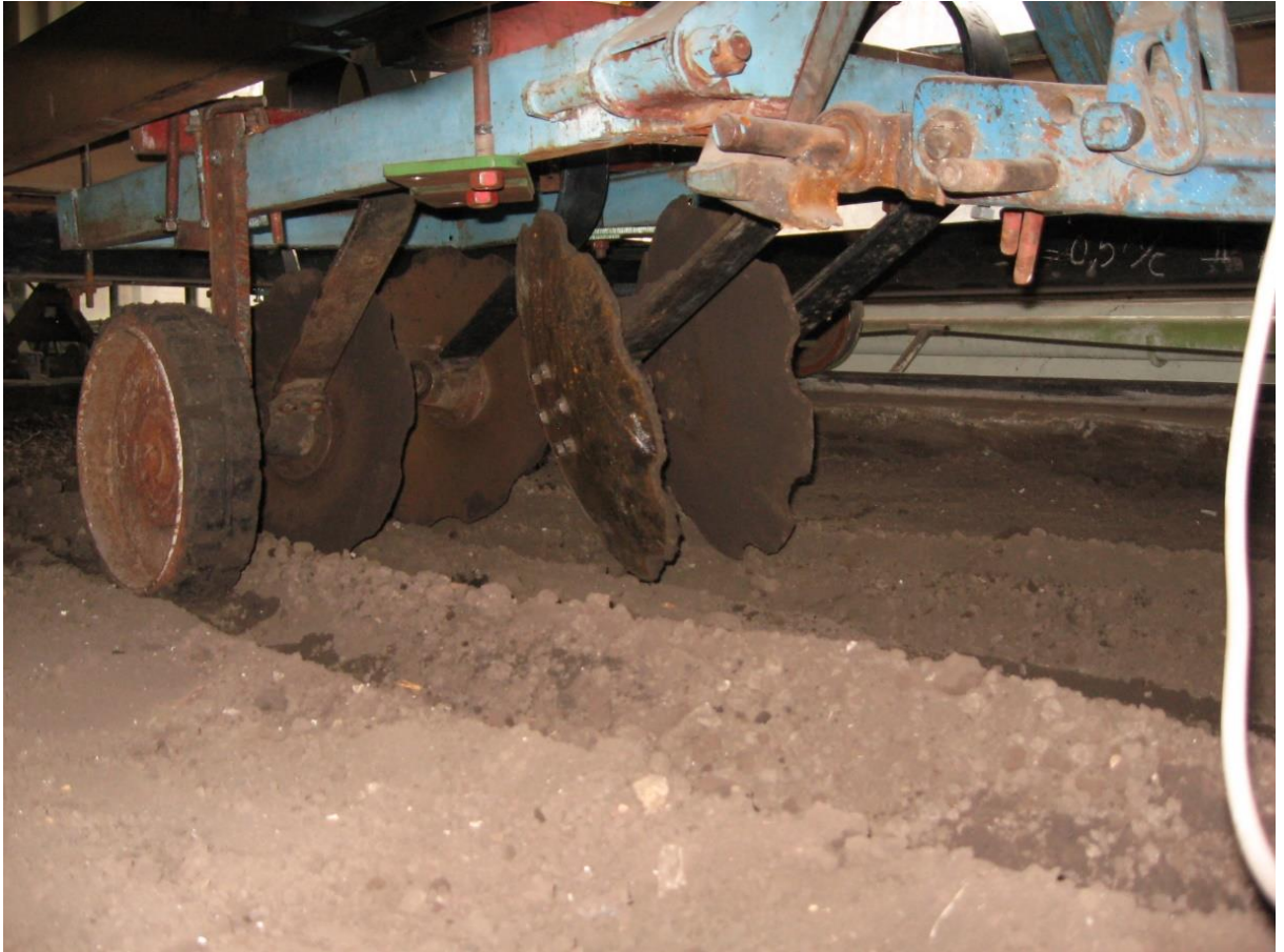
Рисунок 3.4 – Рухома рамка з механізмом регулювання глибини ходу дискових робочих органів
