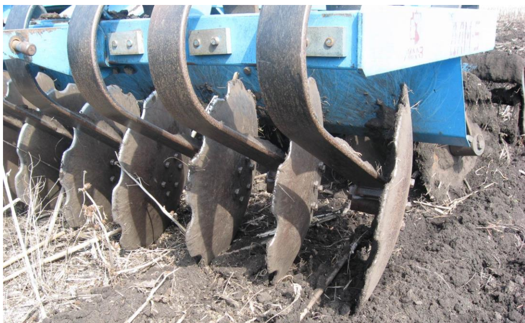
Рисунок 3.7 – Робочі органи дискатора розміром 570 мм
