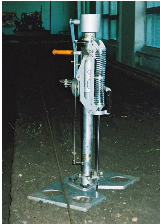
Рисунок 3.17 – Прилад для визначення твердості ґрунту конструкції ВІГОСМа
