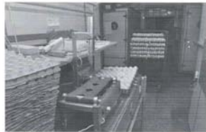
Рис. 1 – Зовнішній вигляд конвексній стрічки для опромінення інкубаційних яєць
