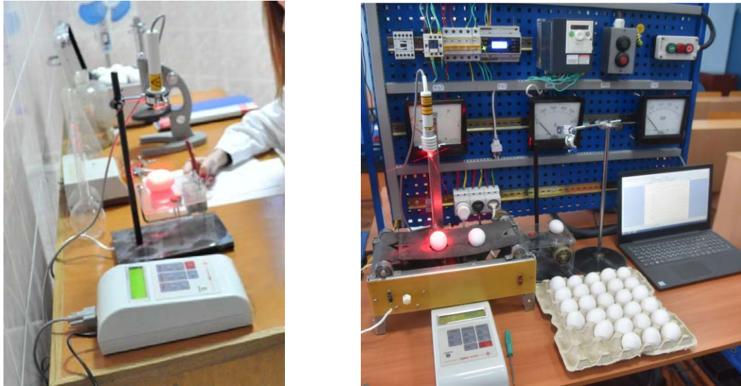
Рисунок 4.13 – Умови проведення лазерної обробки поверхні шкаралупи яйця
