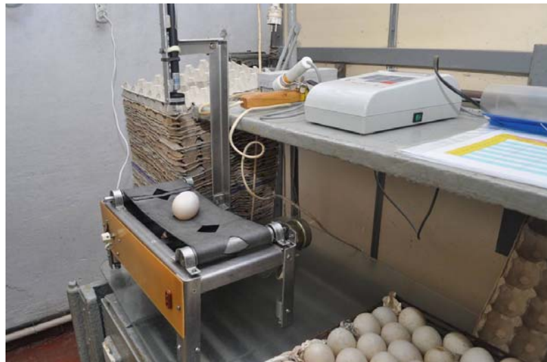
Рисунок 4.14 – Зовнішній вигляд конвеєрної стрічки для опромінювання інкубаційних яєць
