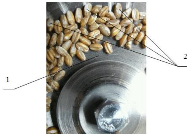
Рис. 4.7 – Поверхня нижнього диска при знятій верхній кришці
