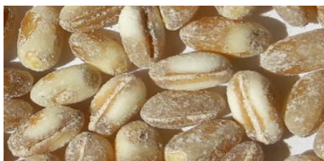
Рисунок 5.2 – Оброблена поверхня пшениці в шелушильній машині (ступінь луцнення 5 %)
