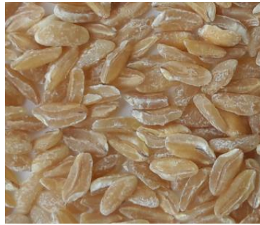
Рисунок 5.5 – Крупа відповідна Полтавської №2 після луцення фракції №1 в шелушильній машині з гладким циліндром
