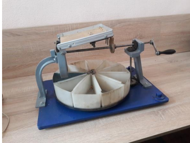
Рисунок 3.21 – Прилад для визначення коефіцієнтів тертя сипких матеріалів
