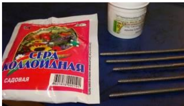
Рисунок 2.9 – Електроди з нанесеним СТС – консистентною речовиною у вигляді сірчаної мазі з додаванням колодної сірки
