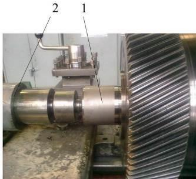
Рисунок 6.14 – Фото валу-шестерні компресорної установки К-104 «ВАВЕТТА»
