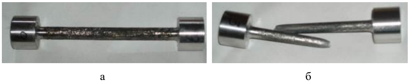
Рисунок 2.17 – Зразок зі сталі 40Х до (а) і після (б) випробування на розрив
