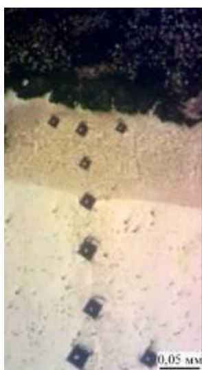
Рисунок 5.43 – Мікроструктура (а) і розподіл мікротвердості (б) поперечного перерізу зразка зі сталі 12X18H10T після ЦЕІЛ і ЕІЛ алюмінієм
