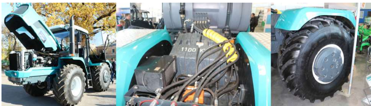
Рисунок 4.15 – Трактор ХТЗ-248К.20 з встановленим баластом на рамі та задніх колесах
