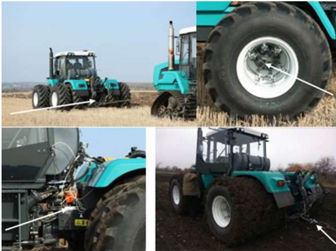
Рисунок 4.3 – Загальний вигляд датчиків та їх розташування на тракторі ХТЗ-242К.20
