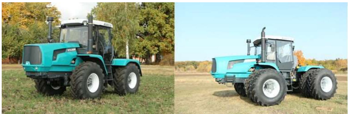
Рисунок 3.2 – Трактор ХТЗ-242К.20 на одинарних (а) та здвоєних колісних системах (б)
