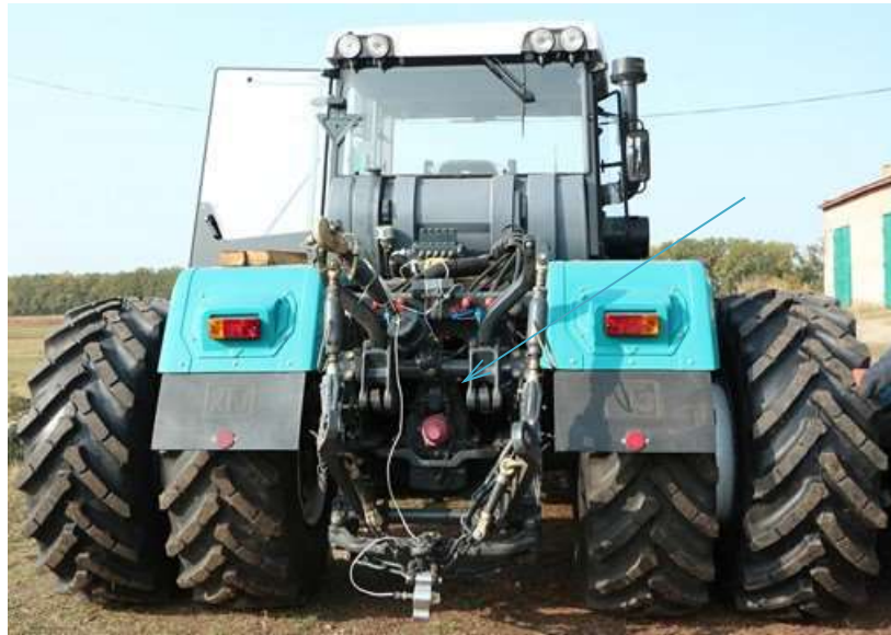
Рисунок 3.3 – Розташування баласту на рамі трактора
