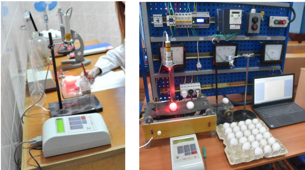
Рисунок 12 – Експериментальні дослідження лазерної обробки поверхні шкаралупи яйця з використання діючого макетного зразка ЕТК
