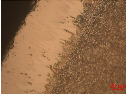
Рисунок 1 – Мікроструктура двофазного борованого шару на сталі X46Cr13, борованої з пасти
