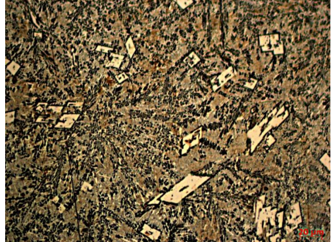
Рисунок 6 – Мікроструктура бориду, карбоборидів та твердого розчину на сталі 15X11MF при більш нерівноважних умовах ( V_H = 500 - 1000 \text{ }^\circ\text{C/c} )
