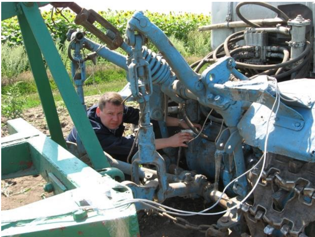
Рис. 4.7. Установка датчиков прискорень і перевірка чутливості системи
