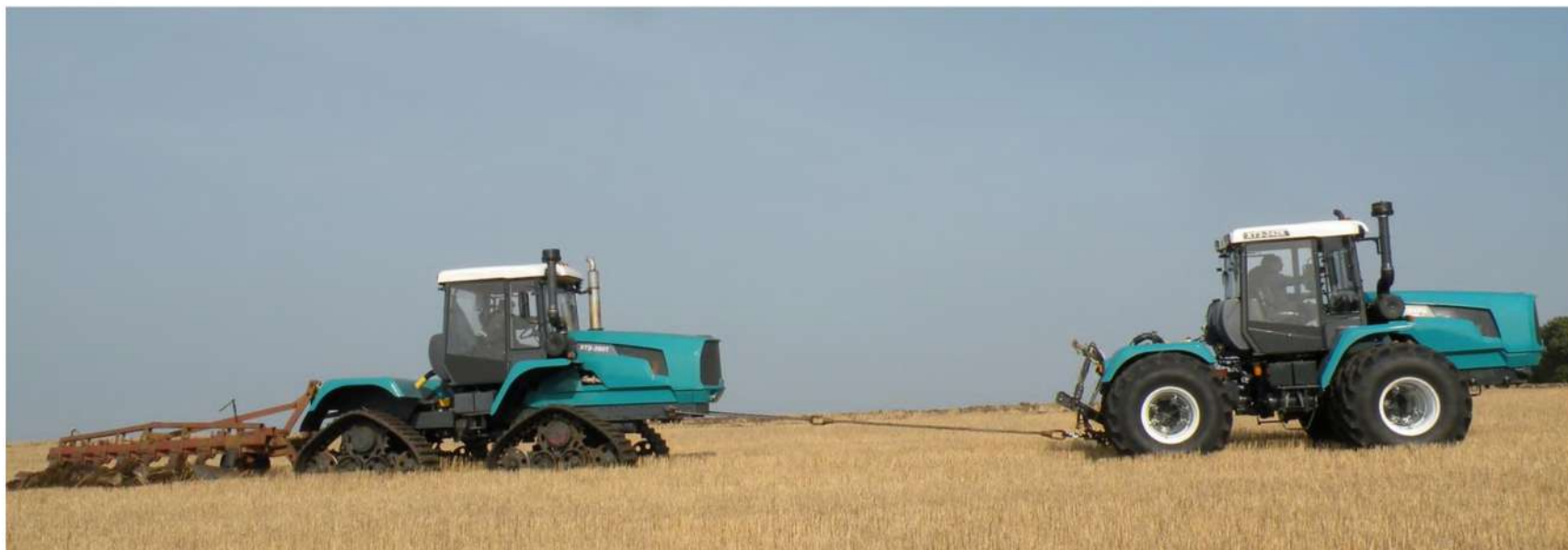
Рисунок 4.13 – Тягові випробування трактора ХТЗ-181.20-07
