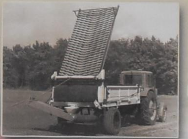
Пневматична машина для висівання силосних добрив. Розробка кафедри експлуатації машинно-тракторного парку. Керівник - професор В.В.Слободяна.
