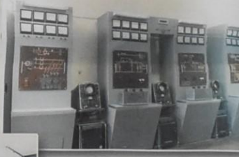
Комплекс уніфікованих моделей для дослідження режимів роботи розподілених електричних мереж
