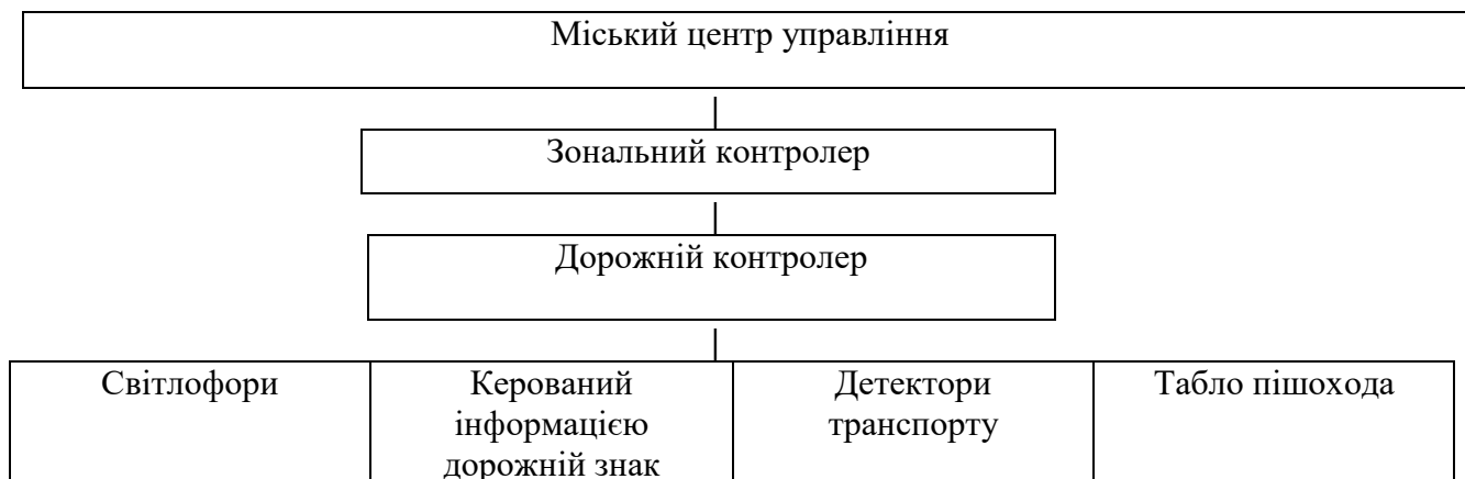
Рис. 1 – Ієрархічна будова автоматичної системи управління
