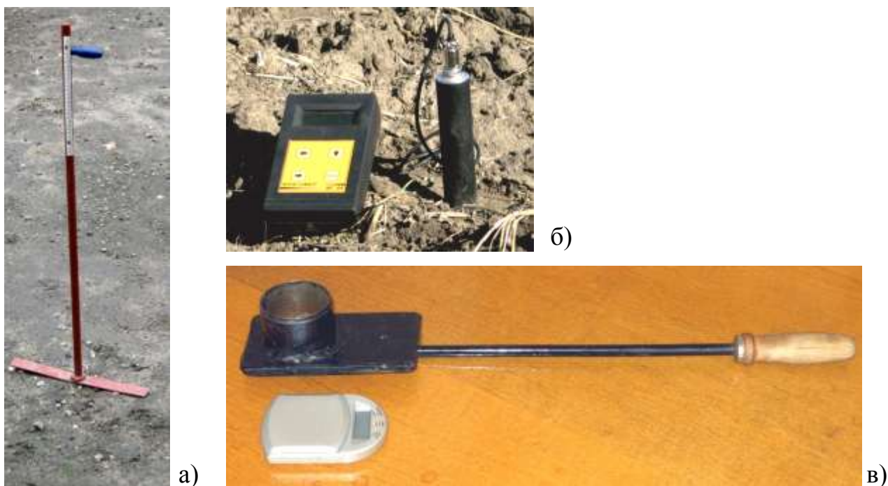
Рис. 5. Прилади для вимірювання глибини оранки (а), вологості ґрунту (б) і щільності агрофону (в).
