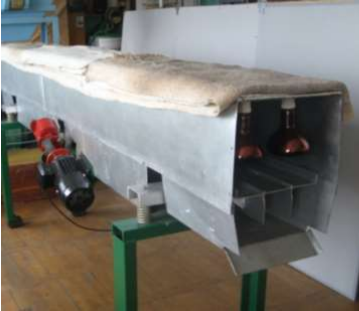
Рис.2.2. Фото експериментальної вібрототкової інфрачервоної сушарки (крильчатка, вивідні патрубки, регулювальний шибер на фото не показані)
