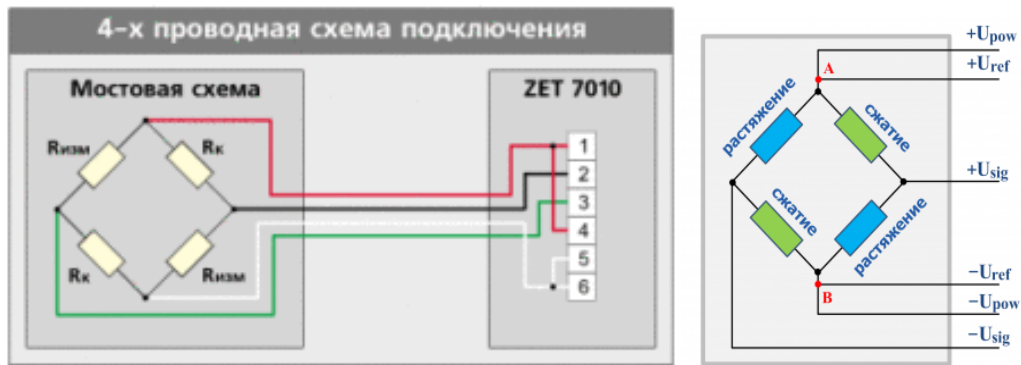
Рисунок 2 – Схема підключення
