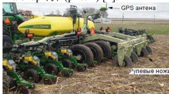
Рисунок 1 – Активне управління сівалкою на бічному схилі
