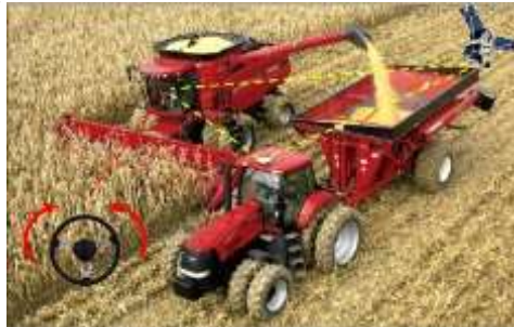
Рисунок 1 – Синхронізація роботи машин за допомогою системи V2V
