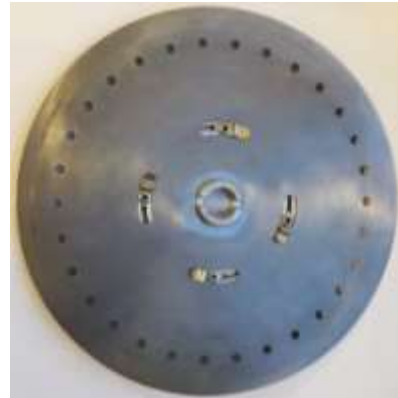
Рис. 3.2 – Висівний диск для дослідної сівалки
