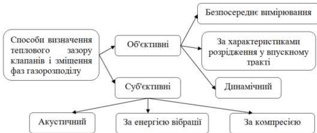
Рисунок 1 - Способи визначення теплового зазору клапанів і зміщення фаз газорозподілу
