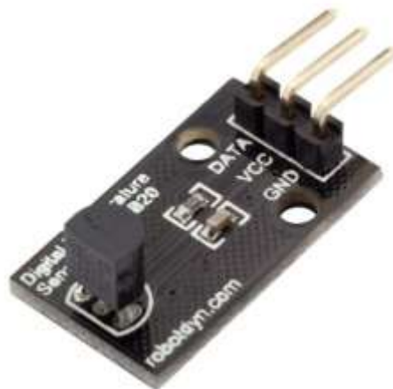
Рисунок 1 – Датчик температури DS18B20 Діапазон вимірюваних температур від -55^{\circ}\text{C} до +25^{\circ}\text{C} .
