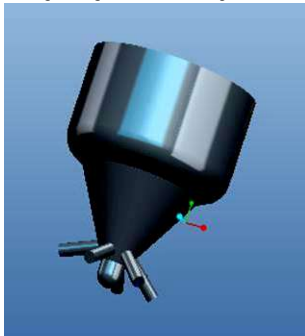
Рисунок – 2 Прийнята геометрія елемента проточна частина розпилювача АЗПІ з одним розпилюючим отвором (а) і розбивка на елементи (сітка) прийнятої геометрії проточної частини (б)
