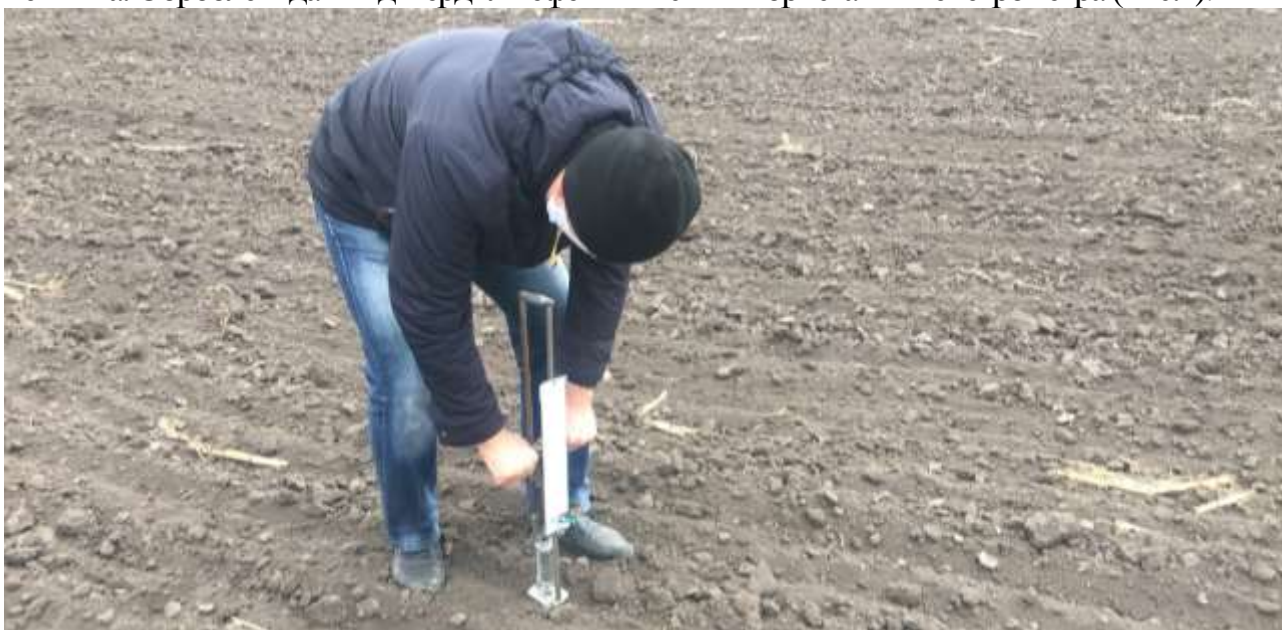
Рис. 2. Заміри щільності ґрунту з використанням твердоміра Ревякіна
