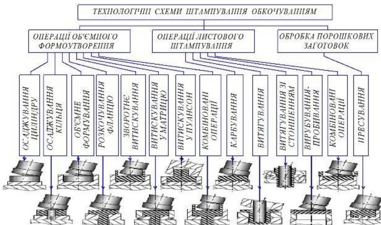
Рисунок 1 – Технологічні схеми штампування обкочуванням
