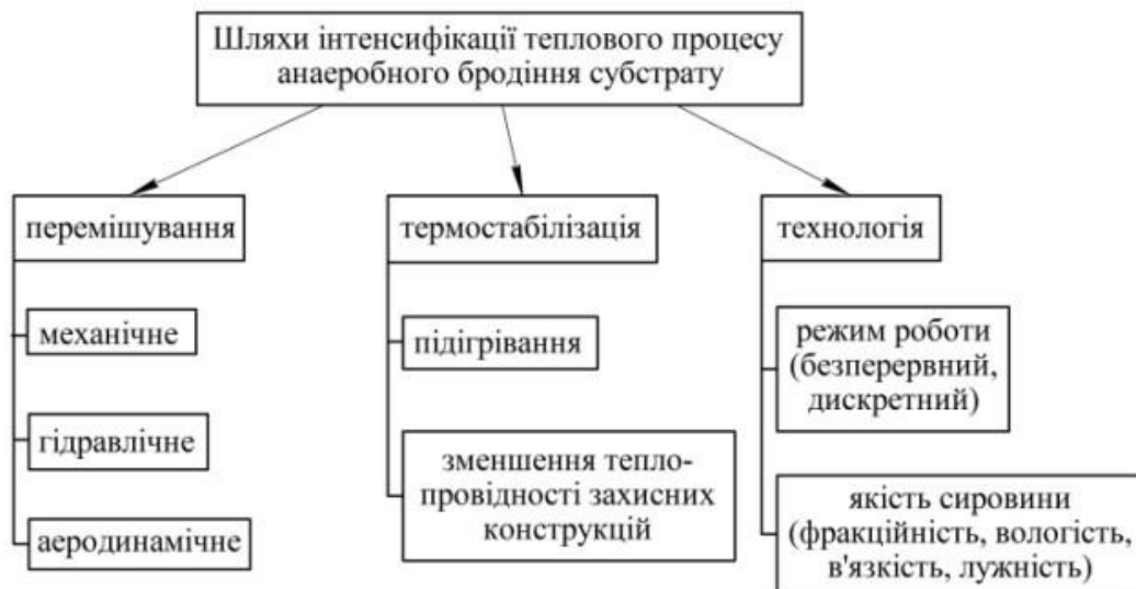
Структурна схема шляхів інтенсифікації теплового процесу анаеробного бродіння субстрату в біогазових установках
