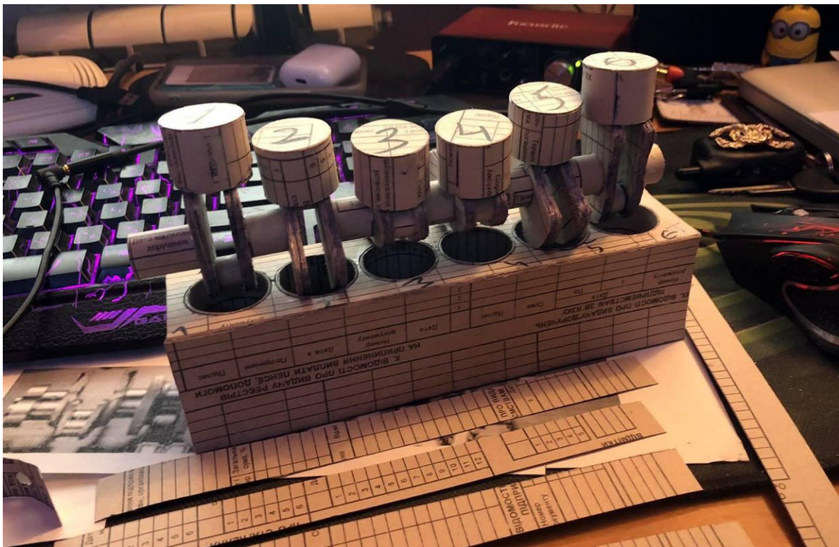
Рисунок 1 – Діюча паперова модель ДВЗ, що працює за принципом «відображення у дзеркалі»
