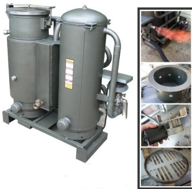
Рис. 1. Газогенераторна установка КУБ (продуктивність газу 10м 3 /год)
