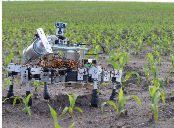
Рис. 1 - Сільськогосподарський робот з самоналагоджувальним алгоритмом роботи
