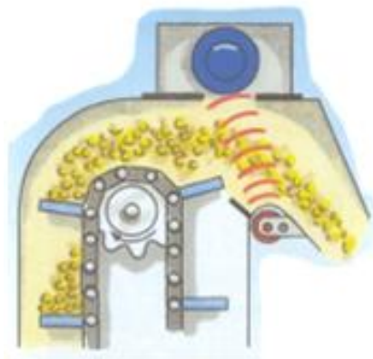
Рис. 7 - Радіометрична система визначення врожайності зерна [0]
