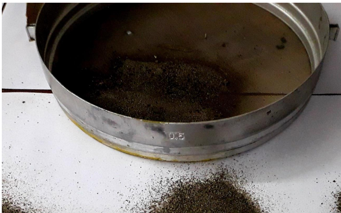
Рис. 2. Определение дисперсного состава лёгких примесей и пыли с помощью набора лабораторных решет с размером 25мкм, 50мкм и 75мкм
