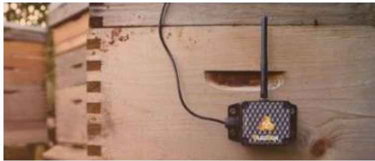
Рис. 4 – Система моніторингу стану вулика "BuzzBox"
