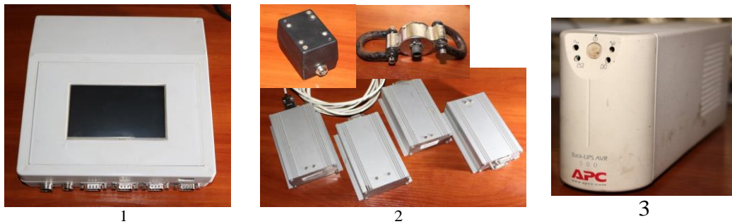
1 – обчислювальний модуль; 2 – датчики; 3 – блок живлення
