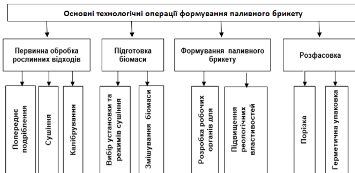
Рис.1 - Існуюча технологія виробництва паливних брикетів
