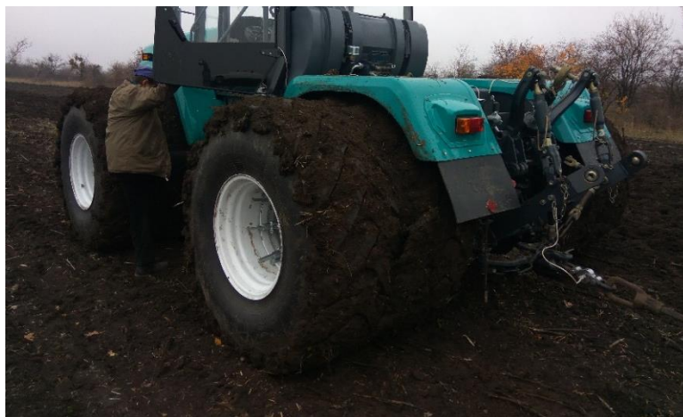
Рис. 4 – Стан ґрунтозацепів шин трактора
