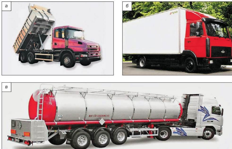
а – самоскид, б – фургон, в – в складі сідельного тягача і автоцистерни – напівпричепа
