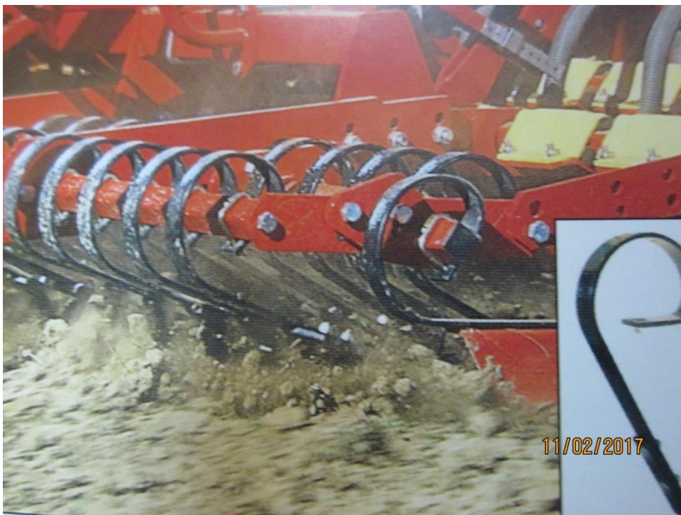
Рис. 4 – Кріплення робочих планок з допомогою пружинних стійок в котку Rexus фірми Väderstad
