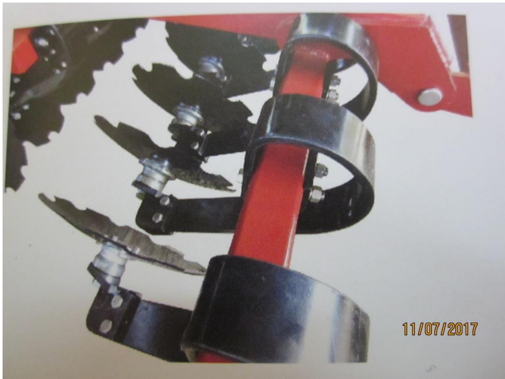
Рис. 9 – Зубчаті диски кріплення пружинними стійками в дисковій бороні луцильника Дукат – 4
