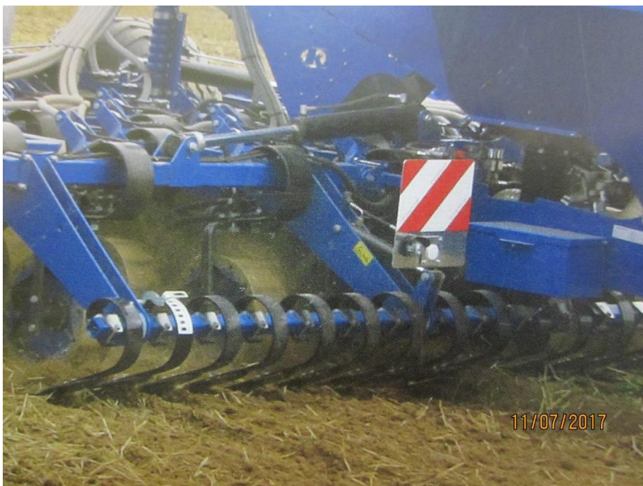
Рис. 2 – Пружинні стійки в посівному комплексі фірми L emken «Компакт-Солітер 9НД»
