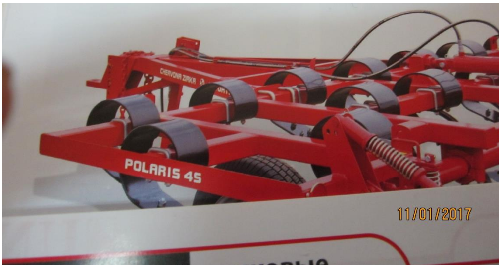
Рис. 8 – Культиватор універсальний POLARIS 4S з пружинними стійками кріплення стрільчатих лап
