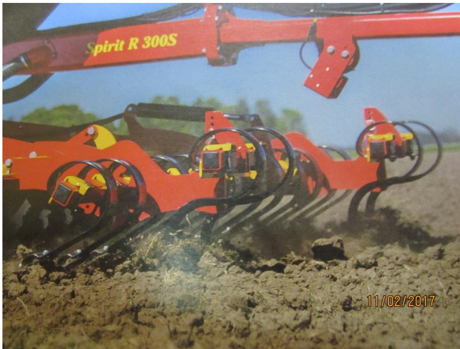
Рис. 3 – Кріплення робочих планок за допомогою пружинних стійок в зерновій сівальці Spirit R 300S фірми Väderstad
