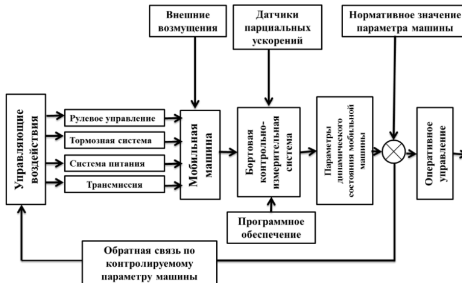
Рис. 4 - Схема обеспечения безопасного использования мобильных машин методом парциальных ускорений
