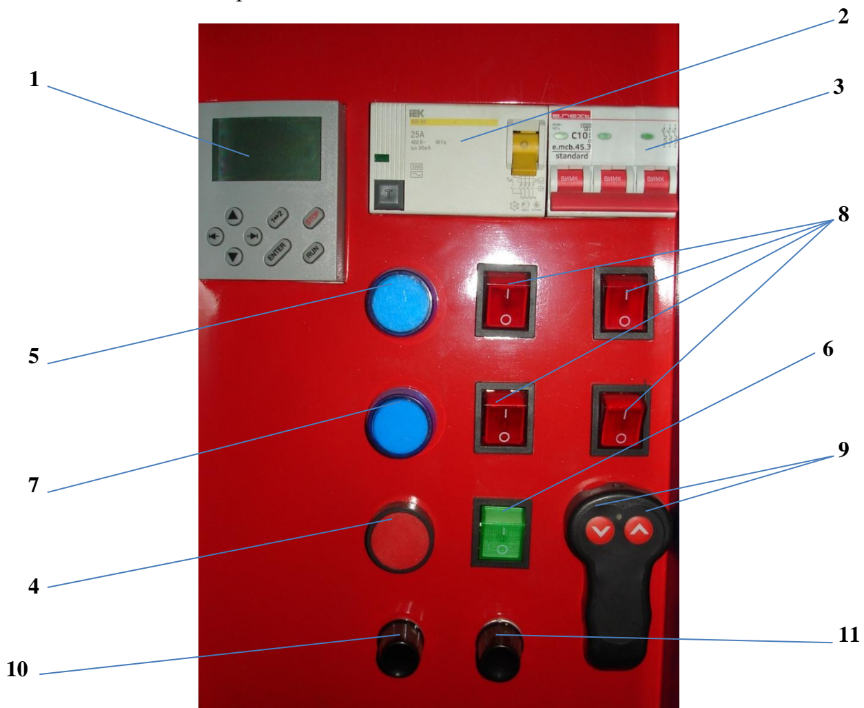
Рис. 2 - Блок управління мехатронної вібраційної насіннеочисної машини:
