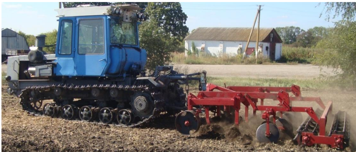
Рисунок 3 – Ґрунтообробний агрегат із серійною начіпною системою на базі трактора ХТЗ-200 і культиватора КЛД-3,0.
