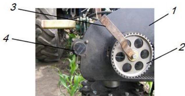
Рис. 3 – Засоби контролю кутової швидкості обертання дисків ротаційного органу:
