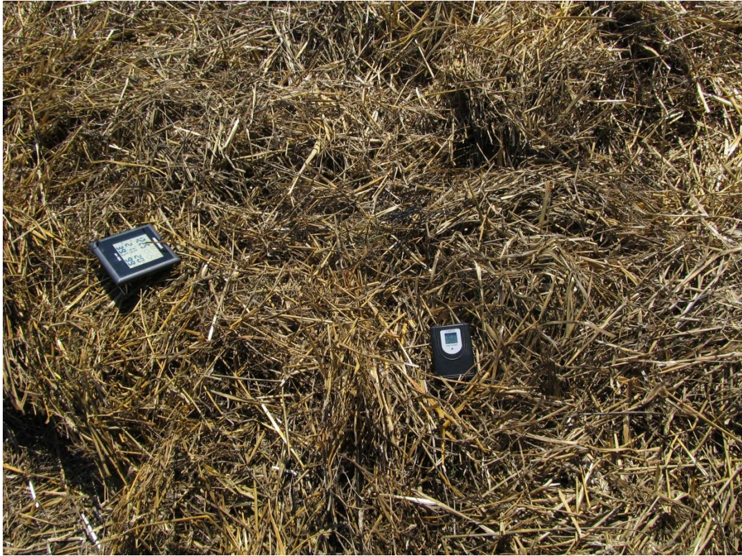
Рис. 2 – Розміщення автономних електронних датчиків температури на дослідних ділянках.
