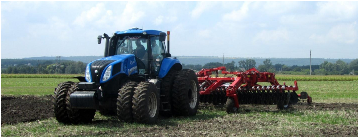
Рис. 2 - Ґрунтообробний агрегат у складі трактора New Holland та дискової борони ДУКАТ-8,0 при випробуваннях
