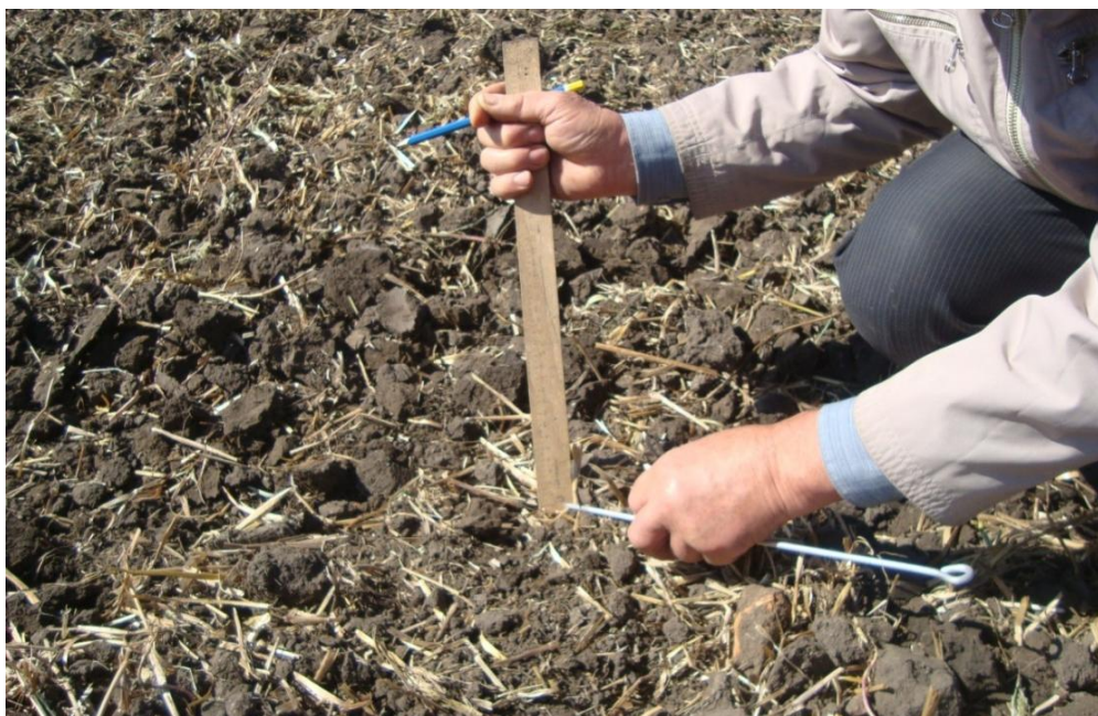
Рисунок 5 – Визначення глибини ходу культиватора КЛД-3,0 в складі ґрунтообробного агрегату на базі трактора ХТЗ-200.
