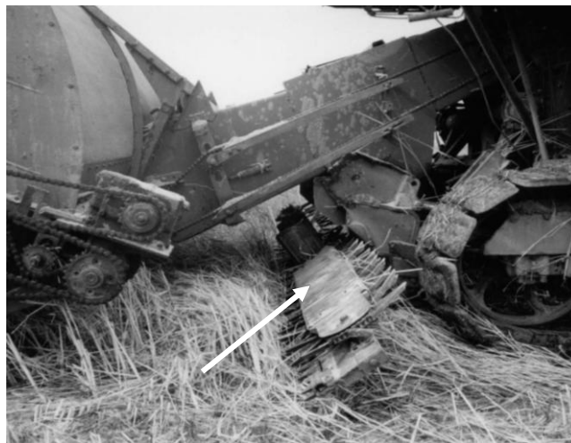
Рис. 2 – Загальний вид різального пристрою з валкоутворювачем (ТДАТУ)
