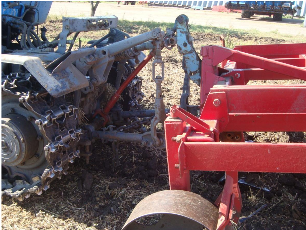
Рисунок 4 – Грунтообробний агрегат із експериментальною начіпною системою на базі трактора ХТЗ-200 і культиватора КЛД-3,0.
