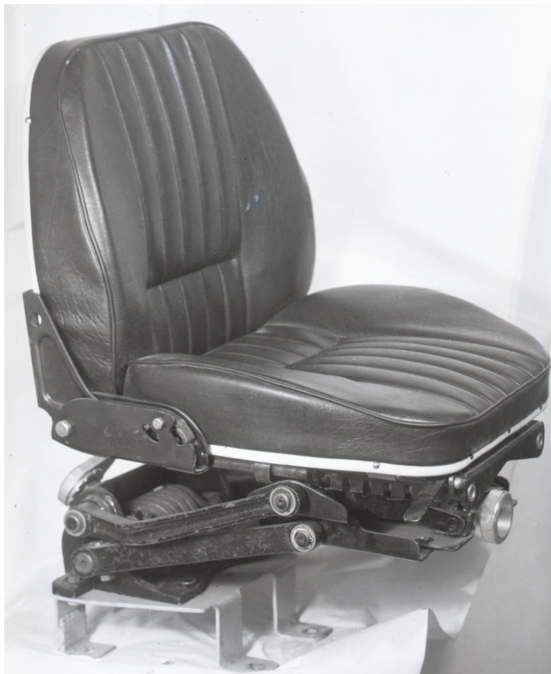
Рис. 4 – Перспективне уніфіковане сидіння водія тракторів і самохідних сільськогосподарських машин
