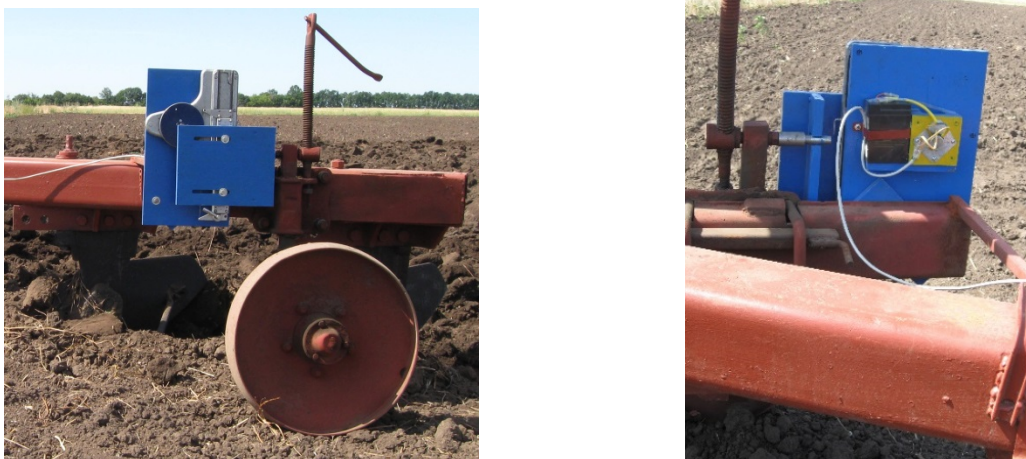
Рис. 7 – Колесо-датчик та датчик-перетворювач в польових умовах
