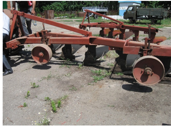
Рис. 3 – Плуг ПУН-5-35, укомплектований додатковим колесом-датчиком та механічним перетворювачем руху
