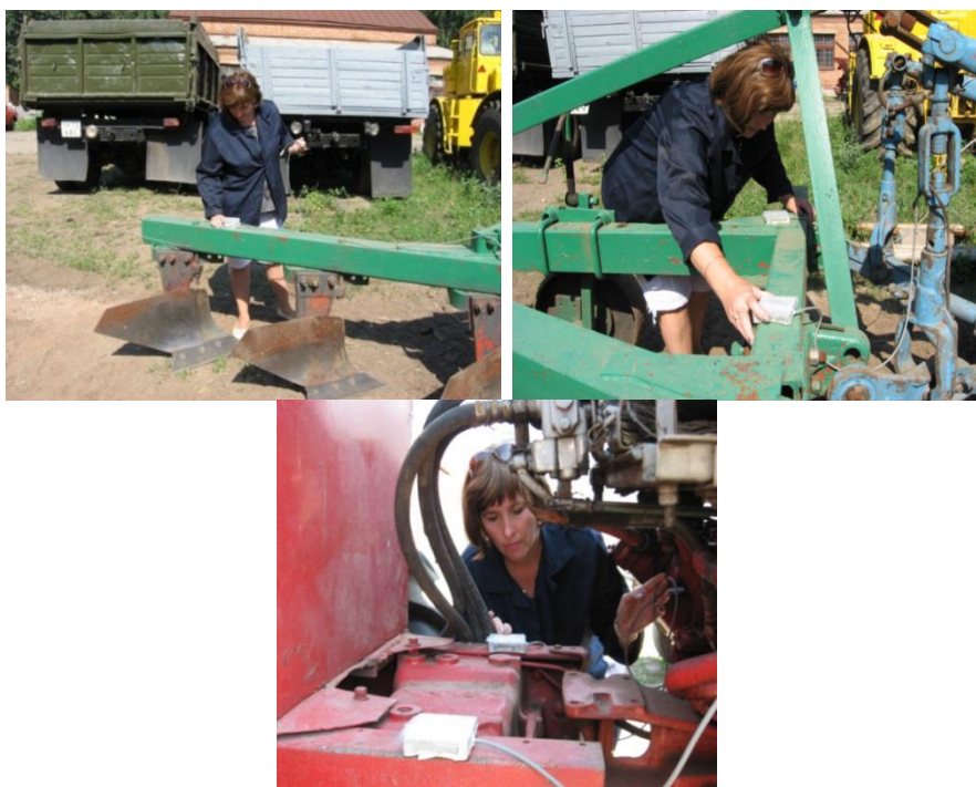
Рис. 2 – Установка датчиков ускорений на пахотный агрегат
