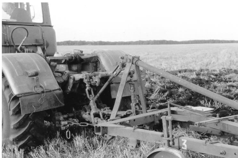
Рис. 9 – Орний агрегат ХТЗ-17021 + ПУН-5-40 з розробленим начіпним пристроєм
