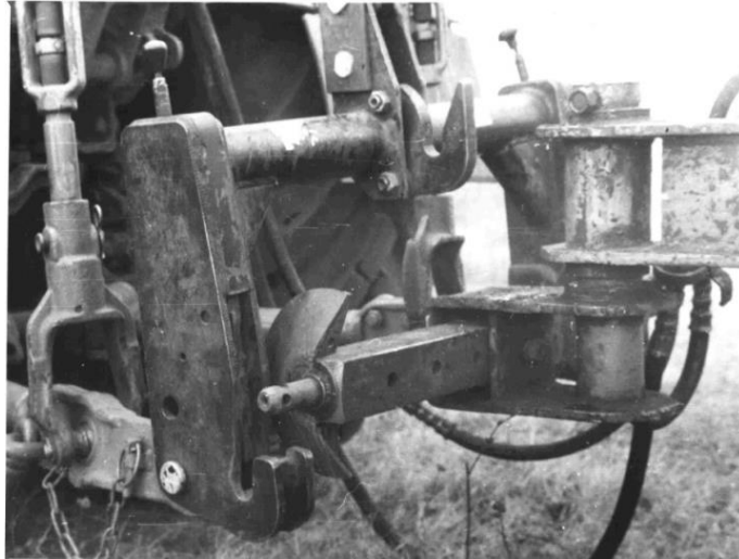
Рис. 8 – Модернізована начіпна система трактора класу 30 кН (розробка ХТЗ, експериментальний варіант)
