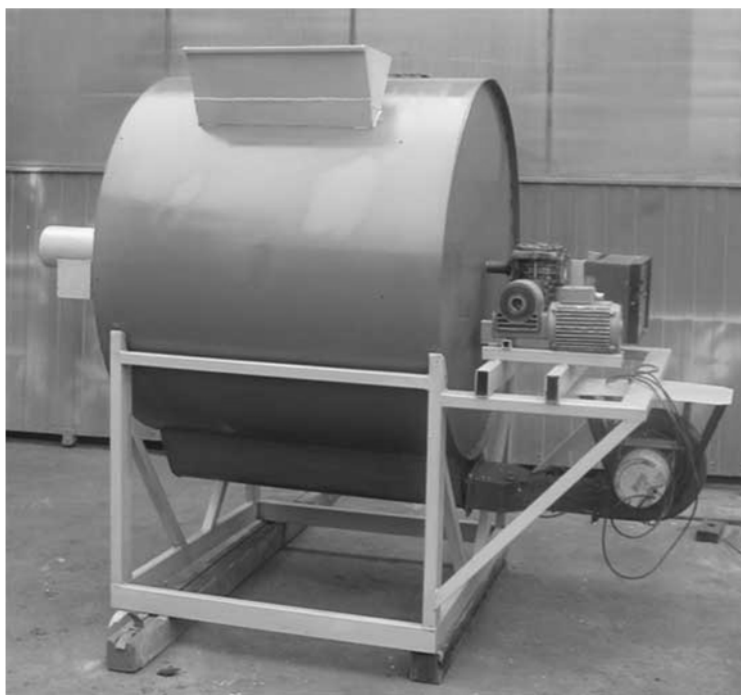
Рис. 4. Загальний вигляд сушарки із спіралеподібною формою сушильної камери
