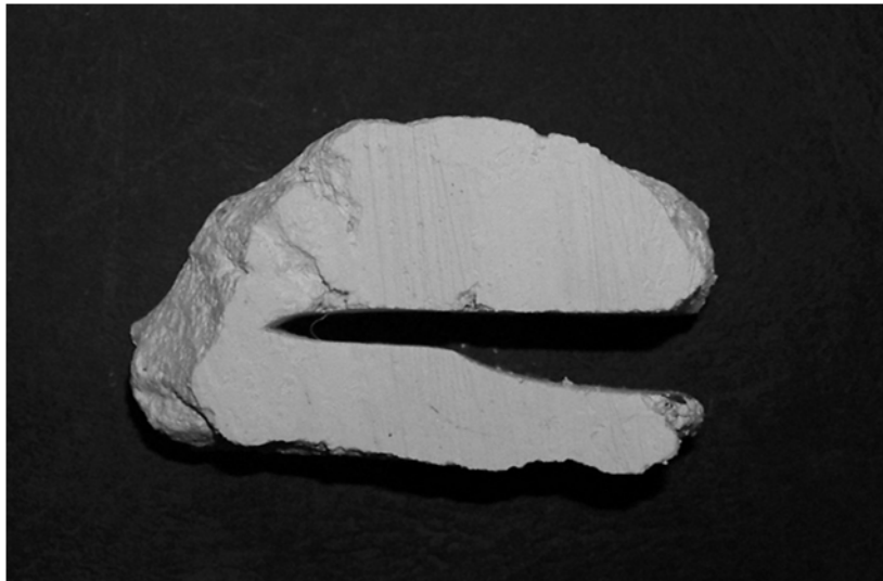
Рис. 3 Загальний вигляд перпендикулярного перерізу відбитка леза дискового робочого органу зміцненого електроерозійним методом (напрацювання 60 га).
