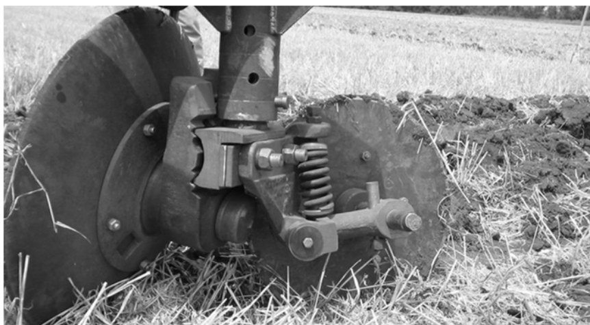
Рис.1. Механізм кріплення диска
