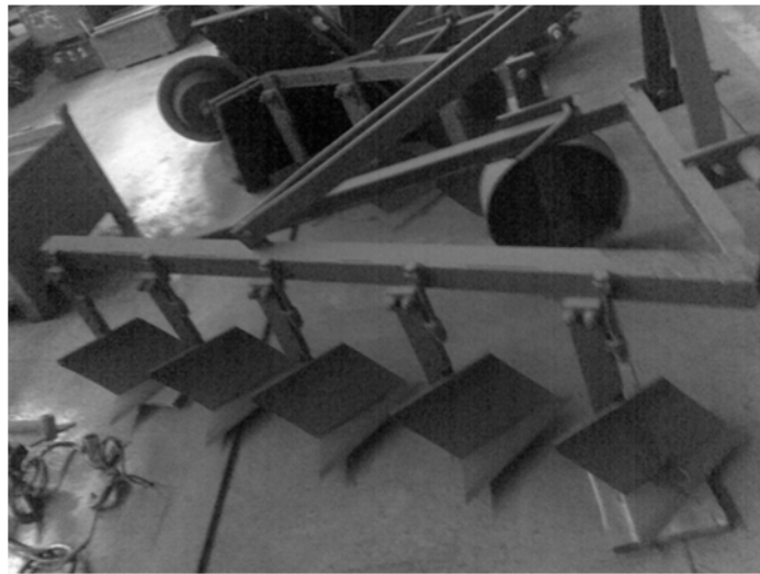
Рис.1. Дослідний зразок плуга-букера (варіант виконання \gamma = 63^{\circ} )
