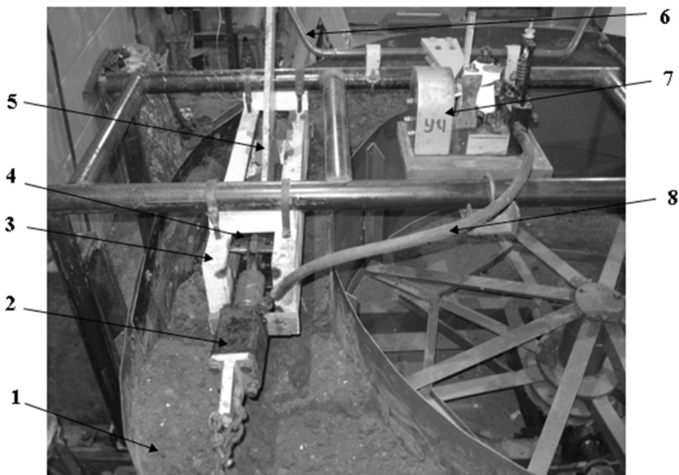
Рис. 2. Установка по моделюванню руху робочих органів ґрунтообробних машин.
