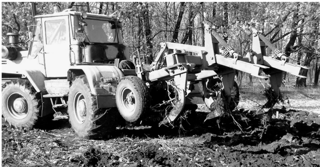
Рис. Агрегат для локального розпушення ґрунту на базі плуга ПЧ-2,5
