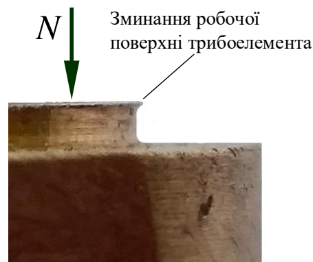
Рис. 4.36. Фрагмент бронзового трибоелемента БрО10С2Н3
