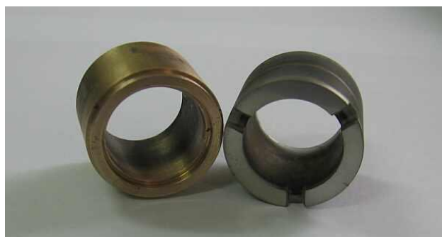
Рис. 2.3. Пара трибоелементів для лабораторних випробувань
