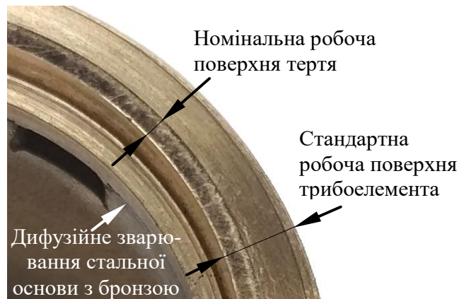
Рис. 4.34. Фрагмент бронзового трибоелемента БрО10С2Н3
