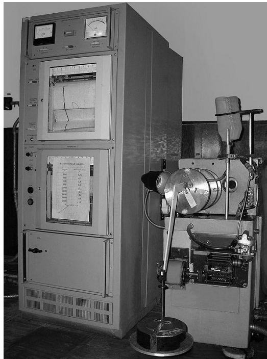
Рис. 2.2. Модернізована стандартна машина тертя 2070 СМТ-1
