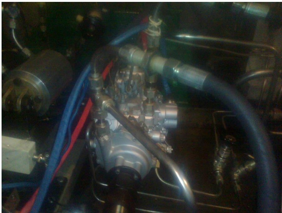
Рис. Б.1. Проведення стендових випробувань агрегату ГП21КМ зі збільшеним ресурсом (при створенні технології ПИ 02-17)
