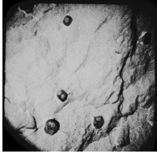
Рисунок 3.32 – Мікроструктура «білого» шару сталі 65Г
