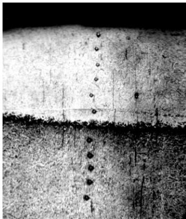
Рисунок 3.35 – Мікроструктура зразків сталі 65Г (а) та У8А (б) після відпалювання та ТФЗ
