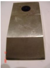
Рисунок 14 – Деревообробний різець із сталі У8А після ТФЗ та експлуатації протягом 3 годин
