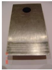
Рисунок 14 – Деревообробний різець із сталі У8А після ТФЗ та експлуатації протягом 3 годин
