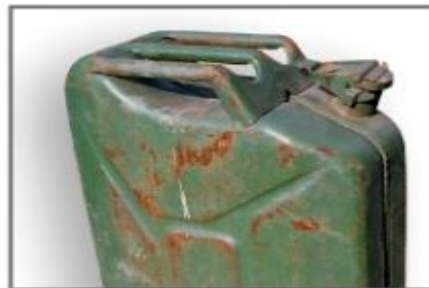
Продукты коррозии топливных емкостей
