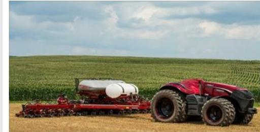
Беспилотный трактор от Case IH: без кабины и тракториста за рулем
