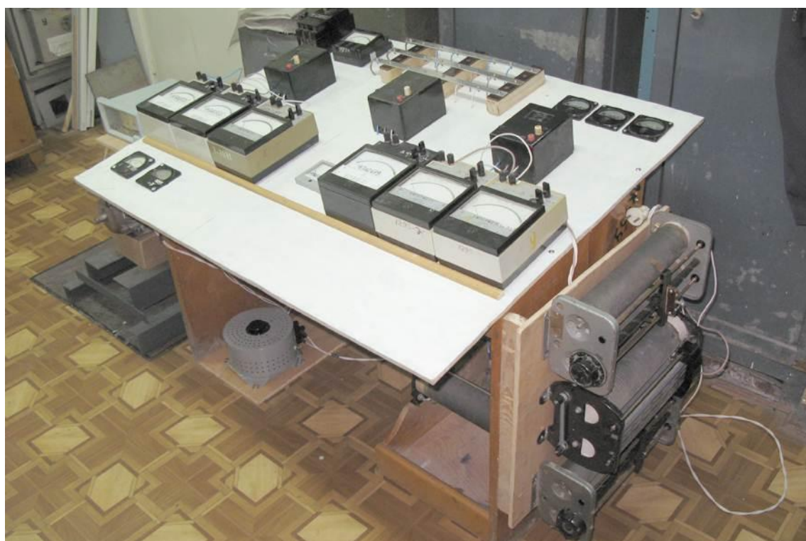
Рис Ж.1 Лабораторна установка для дослідження режимів роботи АД в умовах неякісної електроенергії мережі
