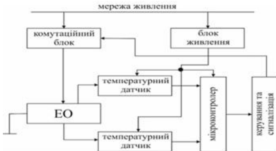
Рис. 4.4 Блок-схема пристрою діагностики теплового навантаження та температурного захисту АД
