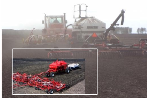
Рис. 2. Агрегати із заднім розташуванням бункера
