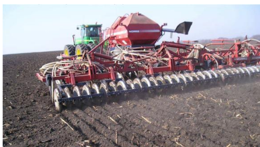
Рис. 1. Сівалка із переднім розташуванням бункера
