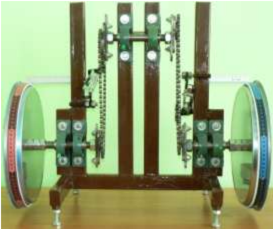
Рисунок Загальний вигляд варіатора оснащеного лімбами для дослідження кінематичних режимів
