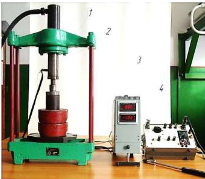
Рисунок Загальний вигляд обладнання для визначення зусилля під час розбирання і складання підшипникових вузлів: 1 – гідропрес; 2 – шток з тензометричним давачем; 3 – аналого-цифровий перетворювач; 4 – підсилювач сигналу тензометричного давача
