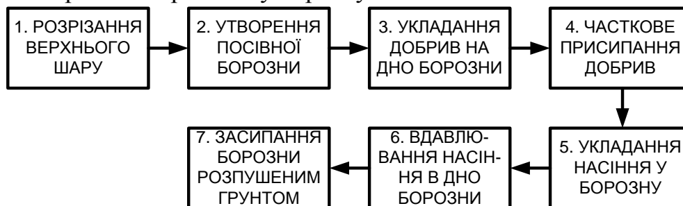
Рис. – Структурна схема сівби зернових культур із вдавлюванням насіння у дно борозни
