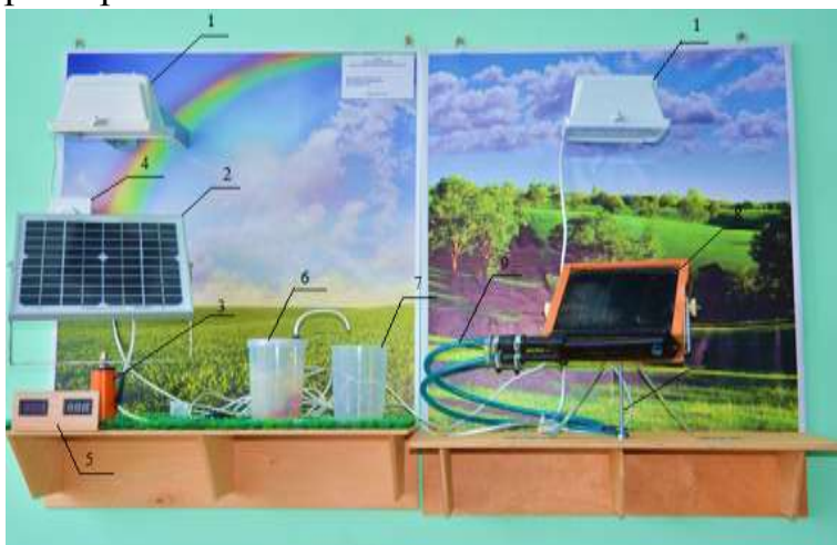
Рисунок 1 – Фото лабораторного стенда – модели ФЭСН с СК
